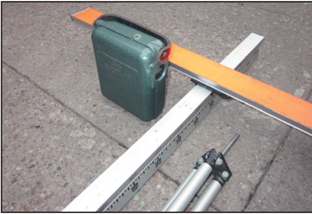
Рис. 58 Автоматический нивелир Коули, штатив, нивелирная рейка и визирная цель.
