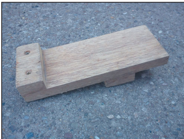
Рис. 147 Деревянный шаблон для неполномерных кирпичей.
