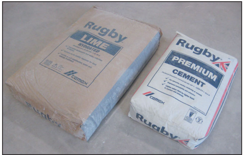
Рис. 18 Сравнение размеров 25-килограммовых мешков обычного портландцемента и гидравлической извести.
