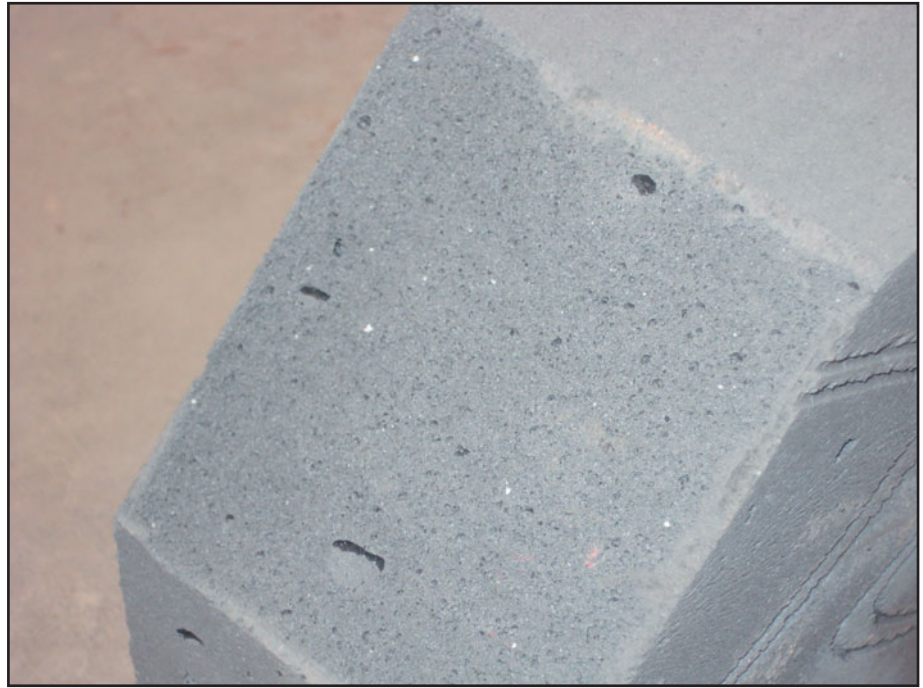
Рис. 38 Как выглядит пенобетонный блок внутри.
