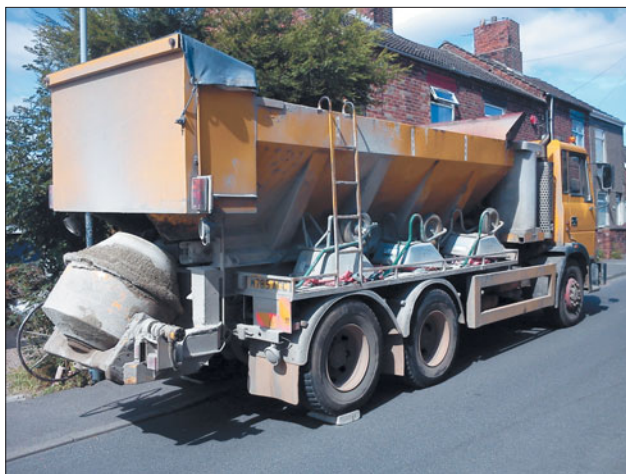
Рис. 14 Грузовой автомобиль, выполняющий доставку компонентов и осуществляющий производство бетонной смеси в небольших объемах.
