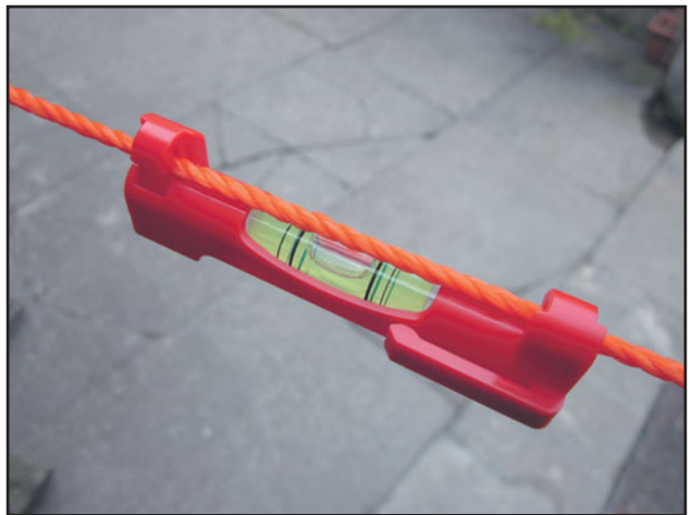
Рис. 52 Подвесной уровень, укрепленный на разбивочном шнуре.
