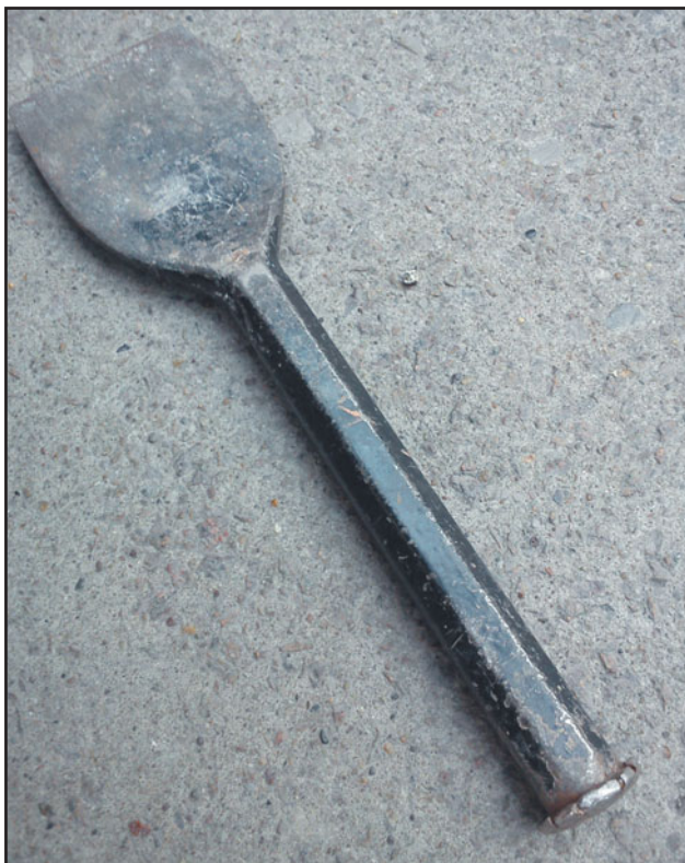
Рис. 80 Тонкое долото с расплющенной шляпкой
