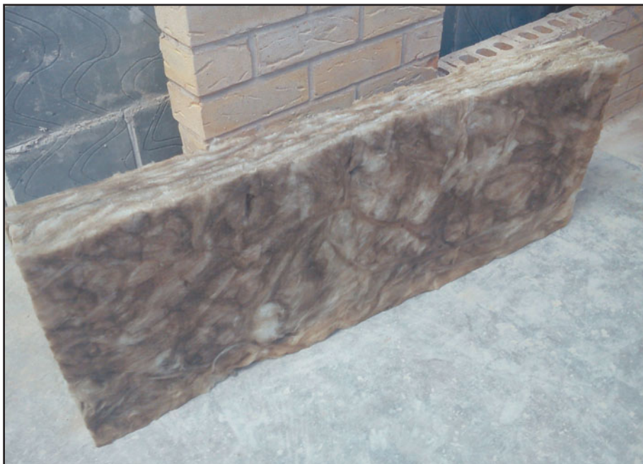
Рис. 173 Теплоизоляционный материал для полного заполнения полости стен.
