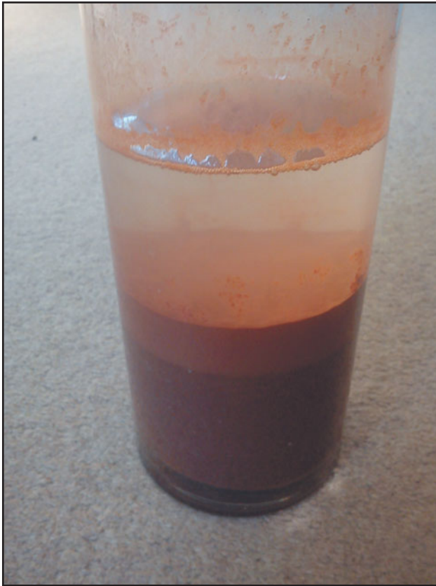
Рис. 22 Результат выполнения теста по определению содержания загрязнений в мягком песке.
