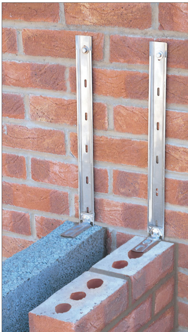
Рис. 276 Универсальная система «Wall-Starter» Staifix, типичный пример подобных систем. Показан процесс стыкования новой примыкающей пустотелой стены с существующей стеной.
