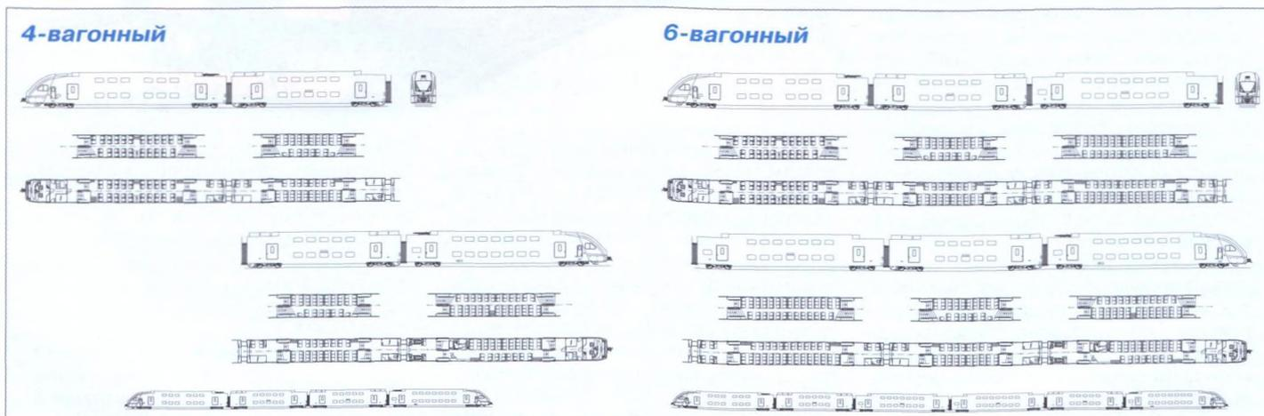
Рис. 3. Компоновочная схема электропоезда ЭШ2 в 4- и 6-вагонном исполнении
