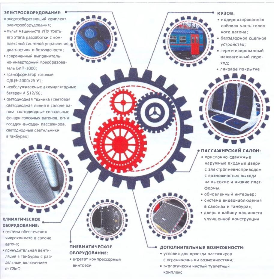
Поезда ЭД9Э оборудованы унифицированными пультами машиниста УПУ новой конструкции. Они как нельзя лучше сочетаются с традиционными системами обеспечения безопасности движения электропоезда. Устройство УПУ, расположение средств отображения информации и органов управления позволяют машинисту при необходимости вести подвижной состав в одно лицо, без помощника. Набор оборудования в кабине дополняют системы оповещения и связи «пассажир-машинист», наружного видеонаблюдения за посадкой и высадкой.
