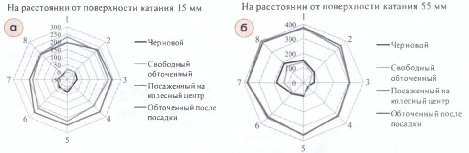
Рис. 3. Распределение остаточных напряжений по окружности бандажа № 32064 на различных расстояниях от поверхности катания в процессе формирования: 15 мм (а), 55 мм (б). Клеймо расположено между сечениями 7 и 8
