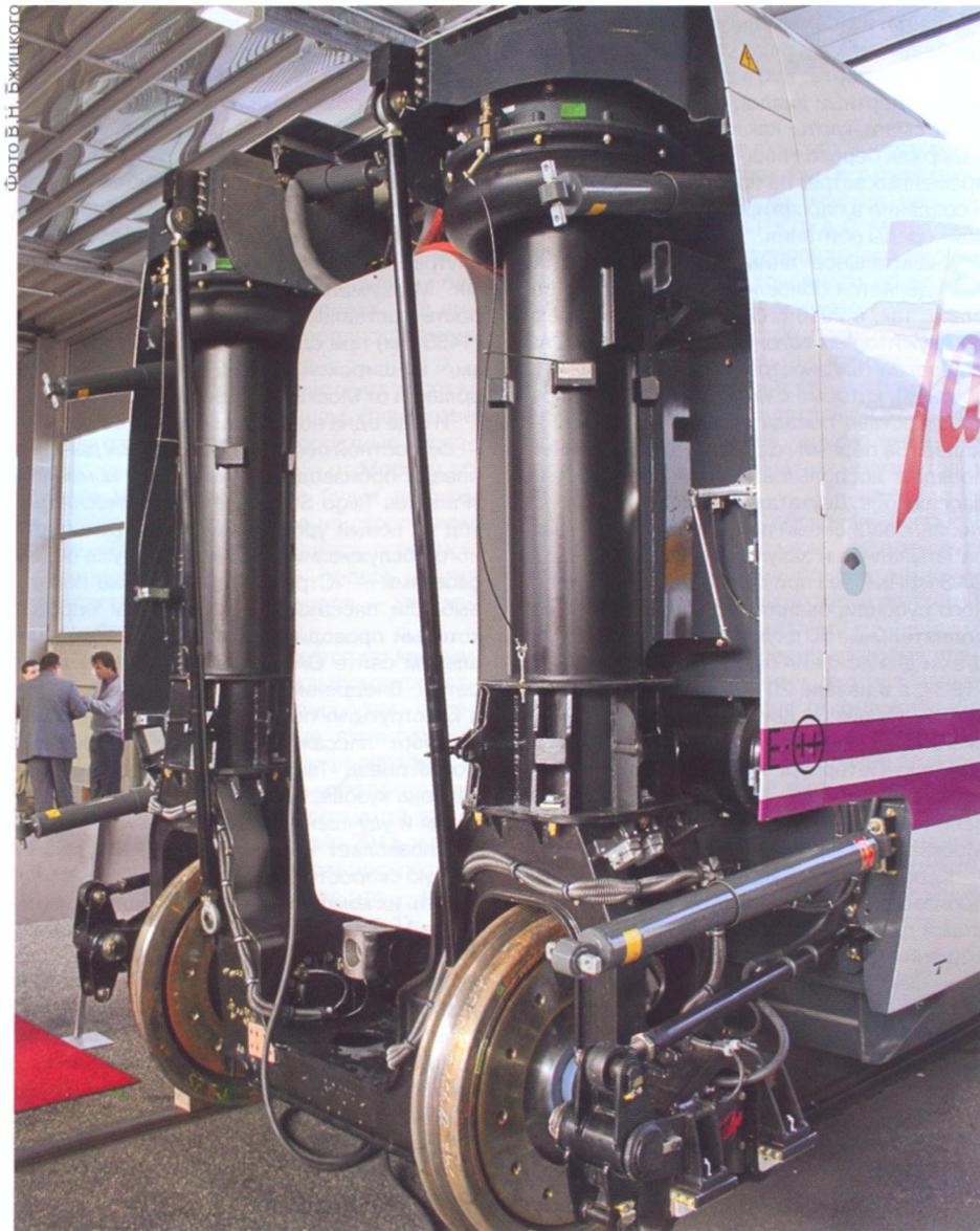
Рис. 3. Система маятниковой подвески вагона «Talго» на «одноосной тележке» сочленённых вагонов
