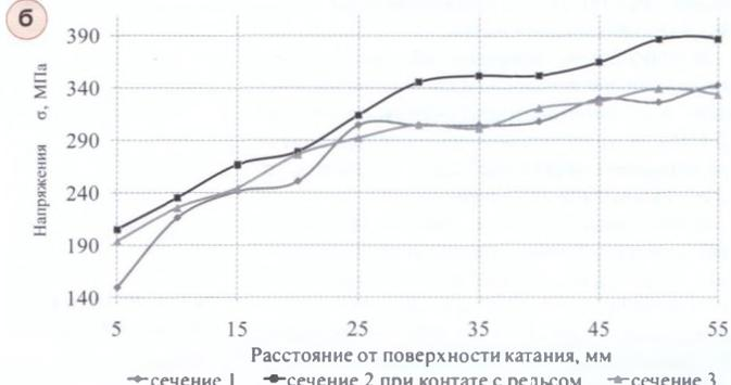
Рис. 8. Распределение напряжений в бандажах, находящихся в ходовой части электровозов 2ЭС6 (а) и 2ЭС10 (б)
