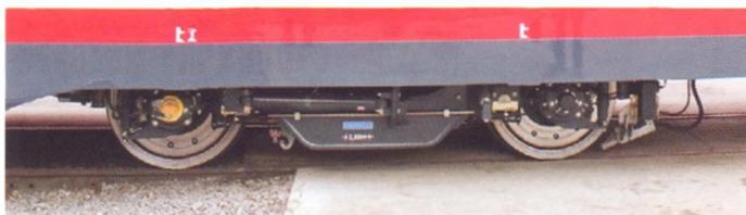
Рис. 4. Тележка электропоезда на пневматической подвеске
