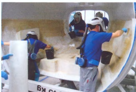
Ламинирование стекловолокном головной части поезда
