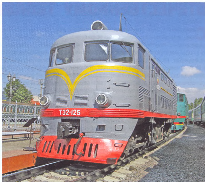
Тепловоз ТЭ2, изготавливавшийся с 1948 по 1955 гг. Харьковским заводом, работал как в грузовом, так и пассажирском движении
