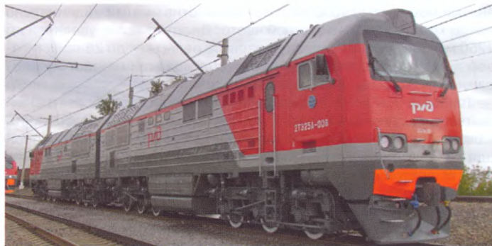
Тепловоз 2ТЭ25А «Витязь» — современный магистральный грузовой тепловоз Брянского завода с асинхронным приводом
