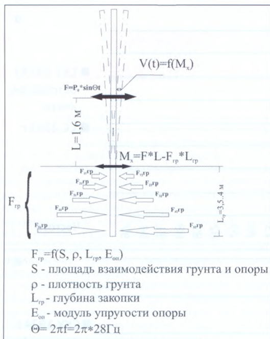
Рис. 6. Модель колебаний опоры контактной сети под воздействием вибратора
