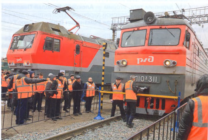
Члены комиссии проводят замеры расстояния между автосцепкой и ограничительной планкой
