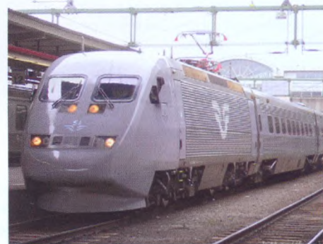
Электропоезд с наклоняемыми кузовами вагонов серии SJ 2000
