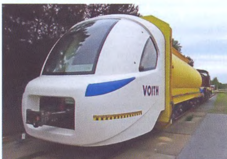
Головная часть поезда с ударопрочными компонентами (концепция Galea®)
