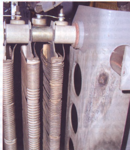
Рис. 6. Переброс электрической дуги по элементу демпферного резистора ЧС7 (вид снизу)
