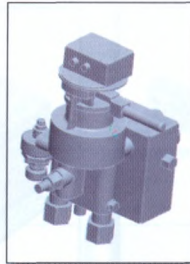
Рис. 5. Кран машиниста 395М-06 с установленными на нем электропневматическим блоком 204 и контроллером 395.370-1
