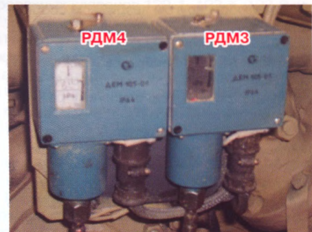
Рис. 10. Расположение реле РДМ3 и РДМ4
