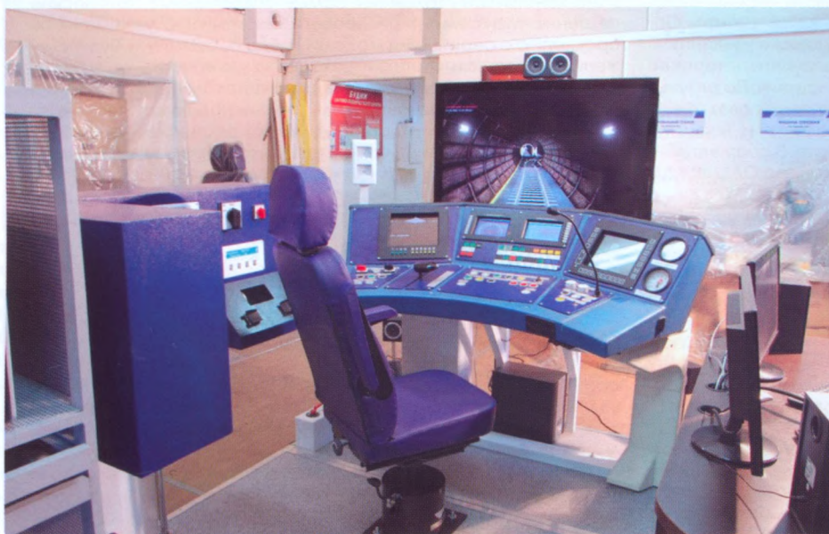
Рис. 6. Тренажер аварийных ситуаций для локомотивных бригад электропоездов метрополитенов
