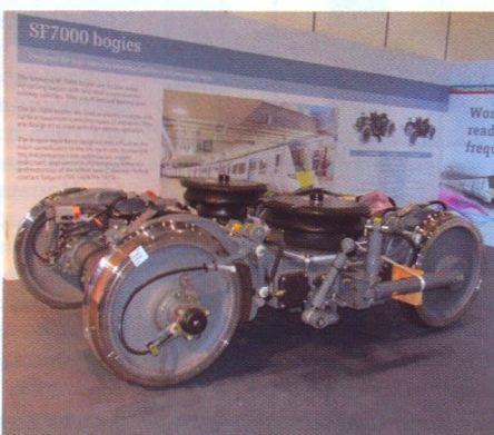
Электропоезд «Desiro City» и его тележка SF7000
