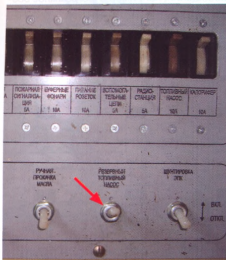
Рис. 2. Тумблер «Резервный топливный насос» (включить при появлении аварийного сообщения «Низкое давление топлива»)
