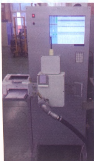
Рис. 22. Стенд с регистрацией параметров для проверки БХВ
