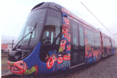
Трамвай «Citadis Comract» с электродвигателем на постоянных магнитах
