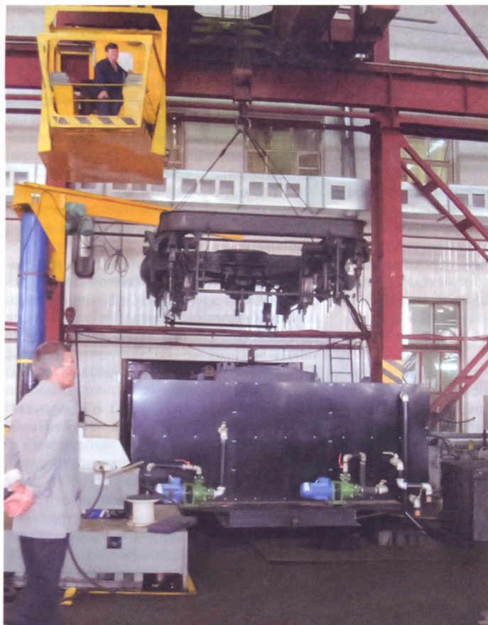
Рис. 2. Процесс загрузки рамы тележки электровоза ВЛ80
