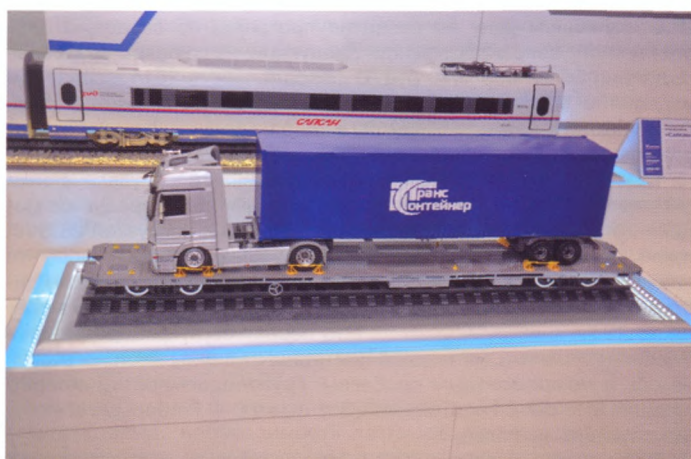
Рис. 3. Вагон-платформа модели 13-9961 для контейнерно-контейнерных перевозок позволит доставлять грузы «от двери до двери»
