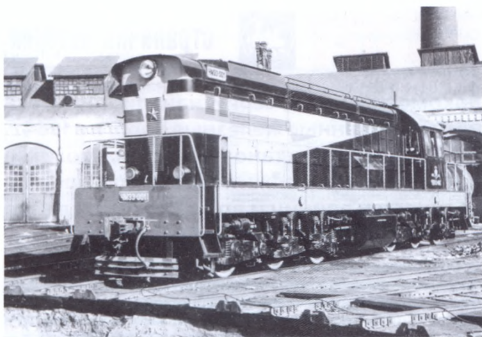
Тепловоз ЧМЭЗ-001 в депо Люблино Московской дороги (1964 г.), повторяющий во многом конструктивное исполнение ТЭМ1
