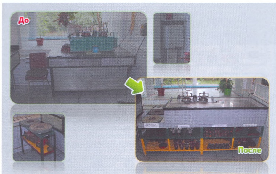
Рис. 14. Позиция для притирки золотника крана машиниста до и после применения методов бережливого производства в автоматном цехе
