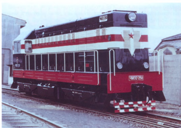
На тепловозах ЧМЭ2 с № 211 (1962 г.) были внедрены бесчелюстные тележки с балансирными буксами
