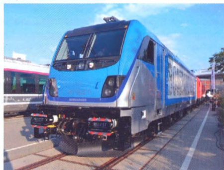
Четырехдизельный аккумуляторный локомотив TRAXX AC «Last Mile» компании «Bombardier Transportation»
