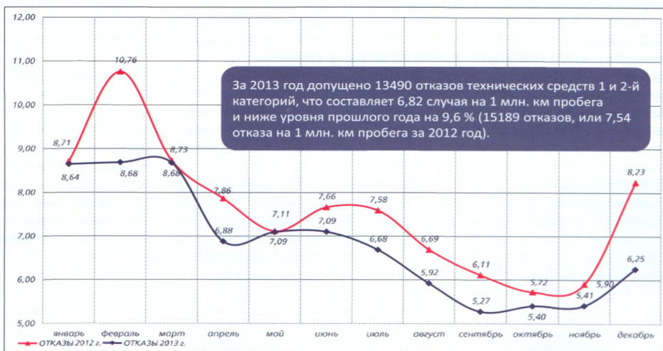
Рис. 2. Динамика изменения количества отказов технических средств 1-й и 2-й категорий по ЦТР в 2013 г. по сравнению с 2012 г. на 1 млн. км пробега (по данным системы КАСАНТ)
