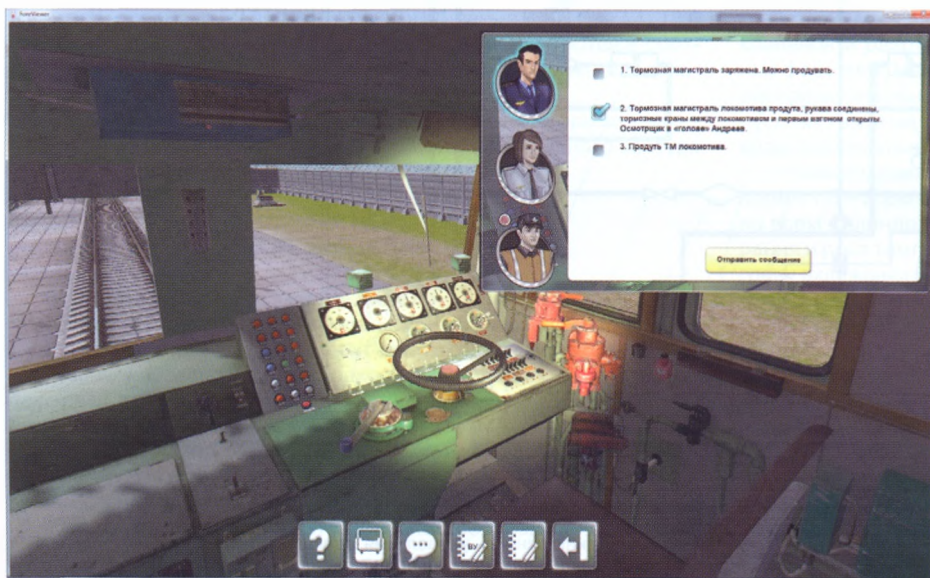
Рис. 3. Групповые занятия на тренажерах по опробованию тормозов для грузовых и пассажирских вагонов
