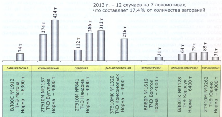
Рис. 2. Показатели превышения установленных весовых норм грузовых поездов с локомотивами, на которых произошло загорание в 2013 г.
