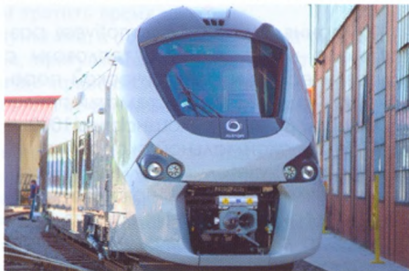
Региональный электропоезд «TER Régionalis» с низким уровнем пола компании «Alstom Transport»
