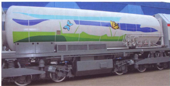
Криогенная ёмкость объёмом 46 м 3 вмещает 20 т сжиженного газа
