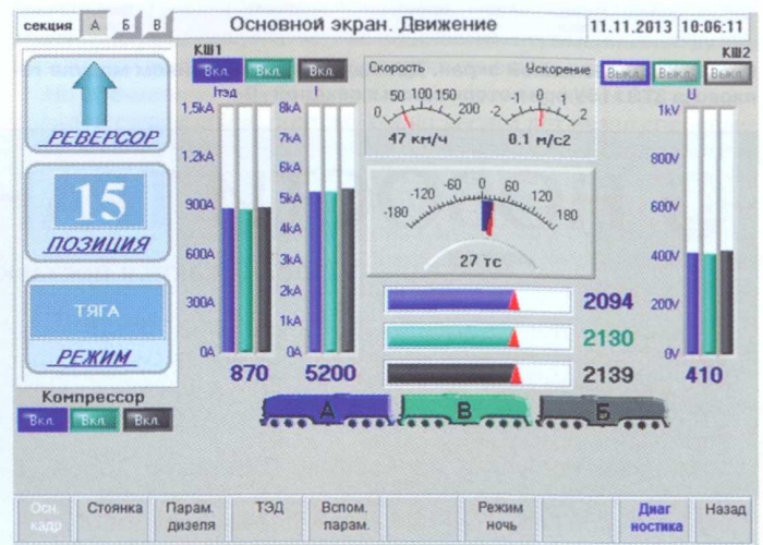
Рис. 5. Кадр «Основной экран. Движение» на дисплейном модуле тепловоза 3ТЭ116У с выбранной секцией «А»
