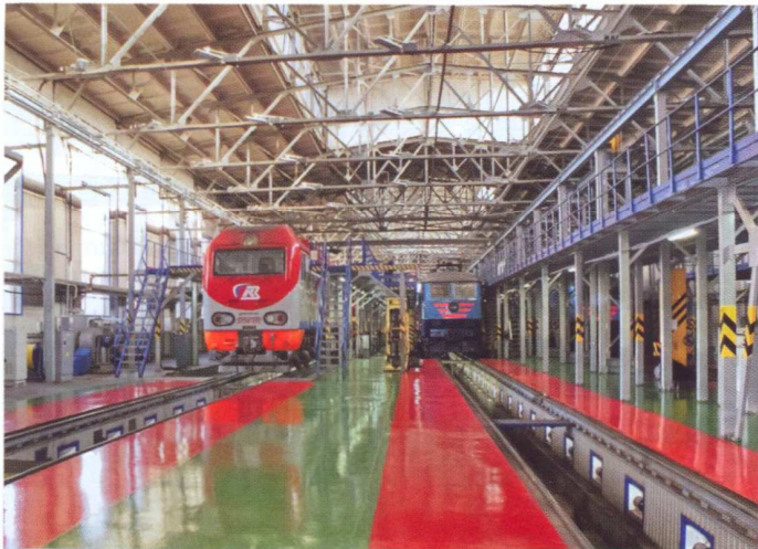
Участок по ремонту электровозов ЭП2К в объеме ТО-3, ТР-1 в депо Санкт-Петербург-Пассажирский-Московский
