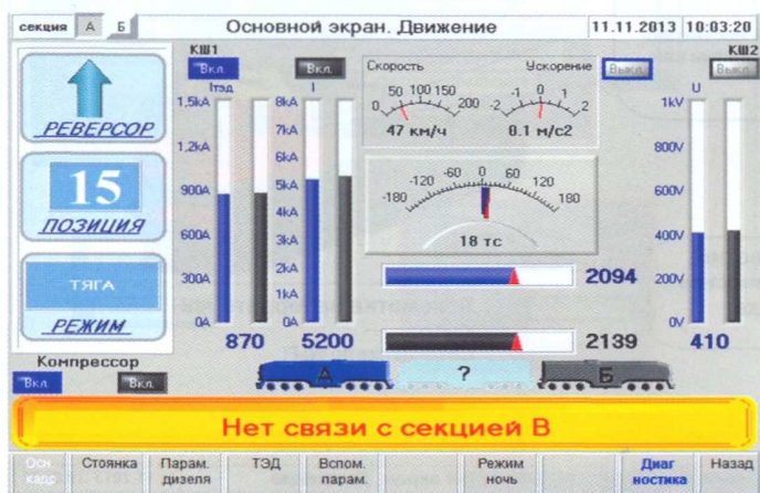
Рис. 8. Кадр «Основной экран. Движение» на дисплейном модуле тепловоза ТЭ3116У при потере связи с секцией «В»
