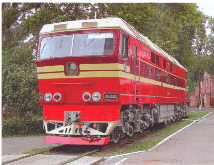
Тепловоз ТЭП70 с дизель-генератором 2А-9ДГ и электропередачей переменного-постоянного тока
