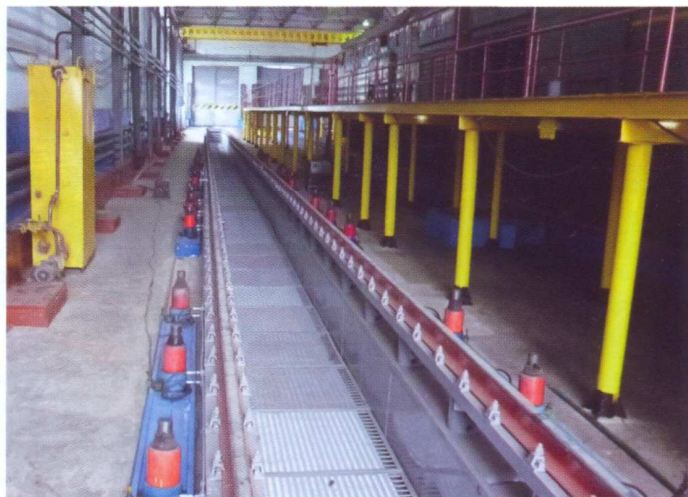
Специализированная позиция для проведения диагностики колесно-моторных блоков в депо Улан-Удэнское
