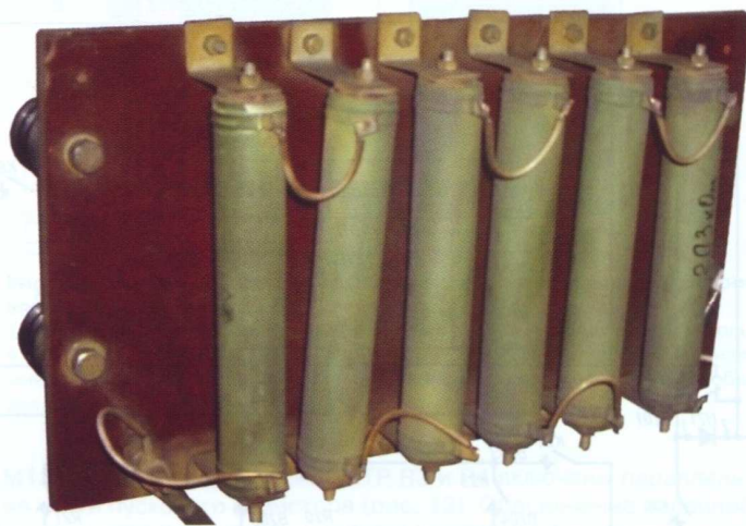
Рис. 18. Разрядный резистор на электровозе ЧС2К
