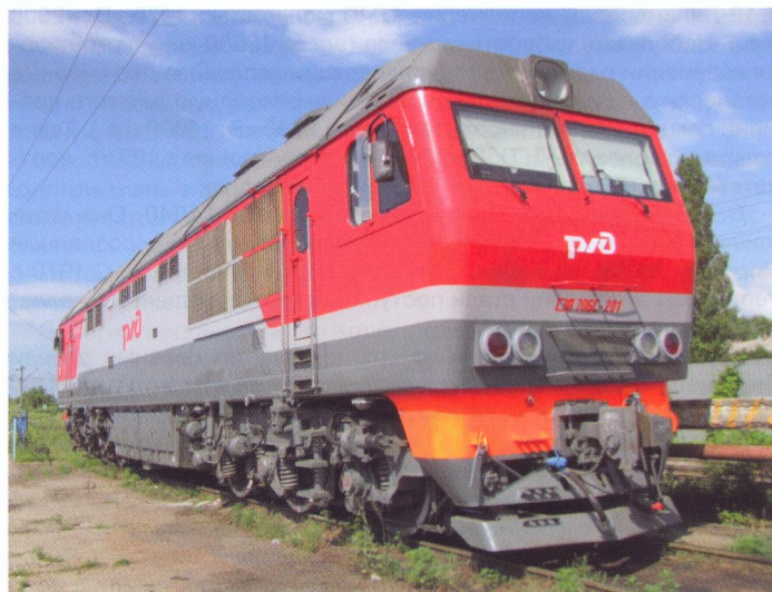
Современный пассажирский тепловоз ТЭП70БС, оборудованный системой электроотопления вагонов поезда
