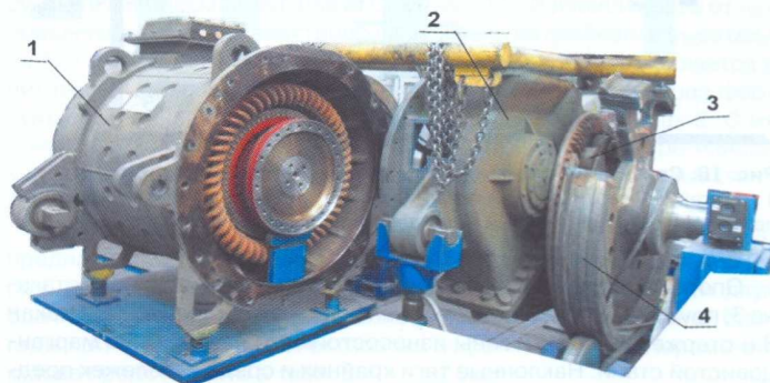
Рис. 12. Монтаж колесно-моторного блока:
