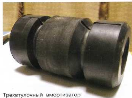
Рис. 8. Модернизация серийных УСЗК по проекту Т1426 (ПКБ ЦТ) (замена серийных упругих элементов на комбинированные трехвтулочные РМЭ)
