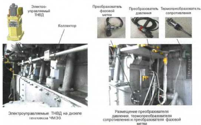
Рис. 8. Расположение основных элементов системы ЭСУВТ на дизеле
