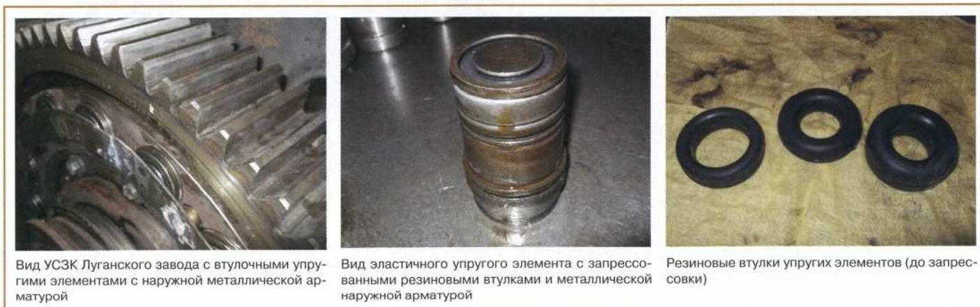
Рис. 1. УСЗК серийного производства Луганского завода с втулочными упругими элементами с наружной металлической арматурой \varnothing 70 мм
