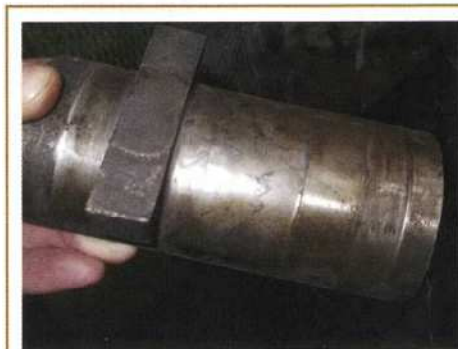
Рис. 4. РМЭ с полуцилиндрами и призматическим упругим элементом между ними (со следами износа, полученного в ходе эксплуатации)
