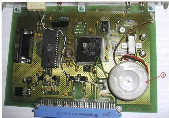
Рис. 5. Установка защитной крышки на тороидальный трансформатор (AM.340.02.01.130) в микропроцессорных передатчиках (МПРД)
