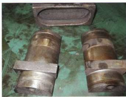
Рис. 4. РМЭ с полуцилиндрами и призматическим упругим элементом между ними (со следами износа, полученного в ходе эксплуатации)
