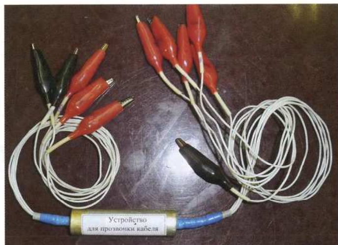
Рис. 7. Внешний вид устройства для прозвонки кабеля
