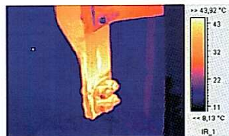
Рис. 13. Нагрев болтового соединения шины вывода тягового трансформатора и шины вспомогательных машин
