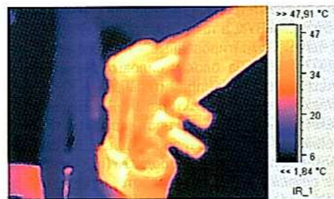
Рис. 7. Нагрев болтового соединения шины от рубильника 82 к линейным контакторам
