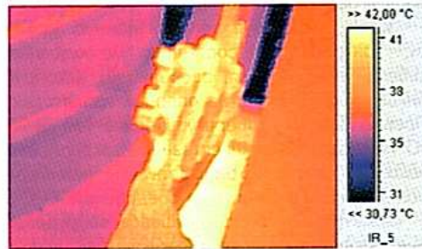
Рис. 5. Нагрев болтового соединения шунта и шины переходного реактора
