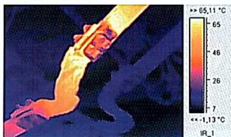
Рис. 1. Нагрев шунта шины собственных нужд трансформатора во второй секции
