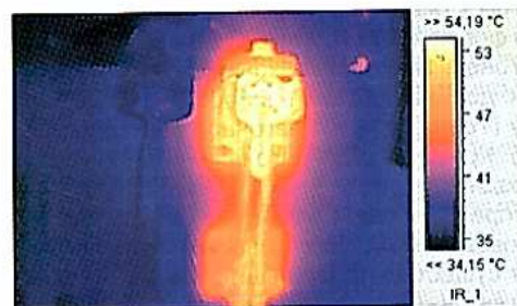
Рис. 17. Нагрев ножа рубильника 111
