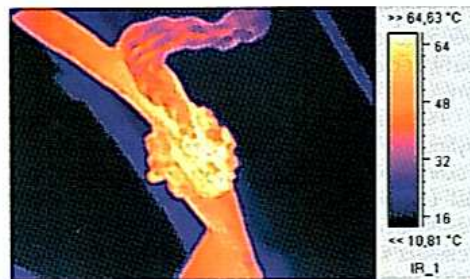
Рис. 7. Нагрев болтового соединения шины от рубильника 82 к линейным контакторам
