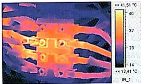
Рис. 15. Нагрев болтового соединения кабеля Э68 рейки межсекционного соединения
