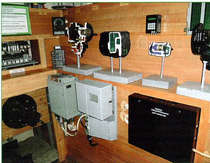
Рис. 15. Оборудование электронного скоростемера КПД-3В на стенде-тренажере «АЛСН с контролем скорости движения»
