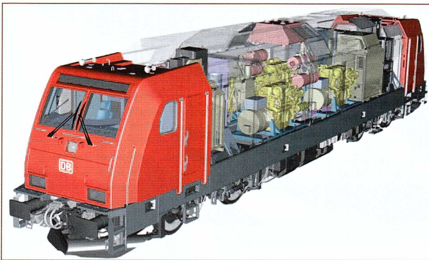
Расположение дизелей на четырехдизельном тепловозе TRAXX DE ME — два по два
