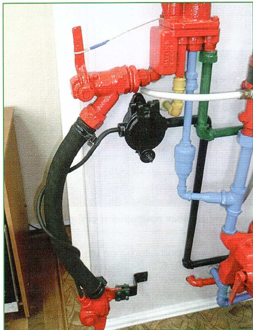
Рис. 10. Концевой рукав тормозной магистра- ли № 369А пассажирского локомотива на изоли- рованной подвеске
