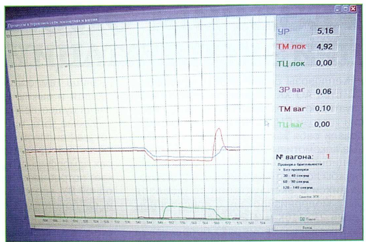
Рис. 12. Демонстрация процессов, происходящих в тормозной системе поезда, на дисплее ПК тренажерного комплекса «Торвест-Пневмо»
