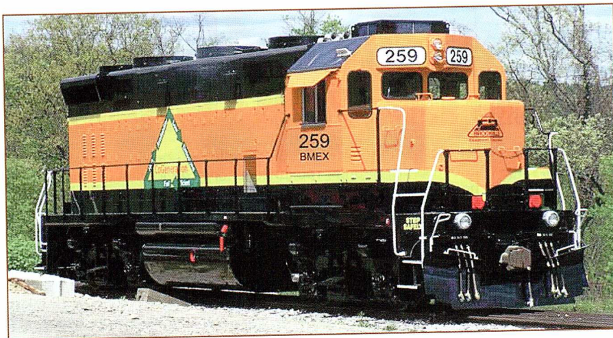
Трёхдизельный тепловоз семейства «CoGeneration»
