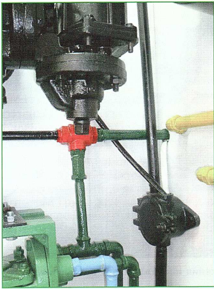
Рис. 8. Дополнительный переключа- тельный клапан № ЗПК для разделения пневматических цепей тормоза пасса- жирского локомотива
