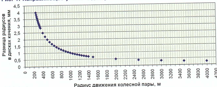
Рис. 2. Направление движения колесной пары (радиус закругления траектории) в зависимости от разницы радиусов в дисках качения
