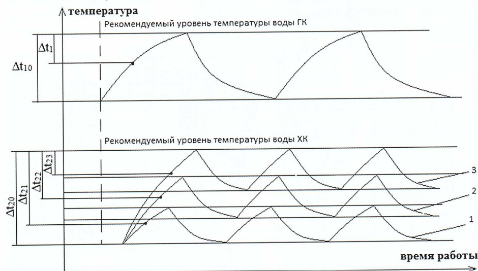
Рис. 1. Характер переохладения воды горячего и холодного контуров в системе охлаждения тепловоза 2ТЭ116 при их регулировании с помощью САРТ релейного типа: \Delta t_{10} и \Delta t_{20} — диапазоны регулирования температур воды, соответственно, горячей (ГК) и холодной (ХК) контуров; \Delta t_1 — уровень переохладения воды ГК; \Delta t_{21} , \Delta t_{22} и \Delta t_{23} — уровни переохладения воды ХК, соответственно, при работе одной, двух и трех вентиляторных установок
