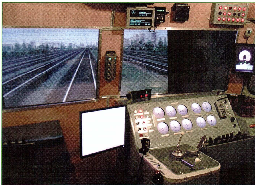
Рис. 2. В кабине тренажера машиниста нового поколения (электровоз ВЛ80С), установленного в депо Лоста
