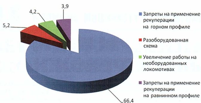
Рис. 8. Суммарные потери электроэнергии (млн кВт·ч) от запретов на применение рекуперации, разоборудованных и необорудованных электровозов системами рекуперации
