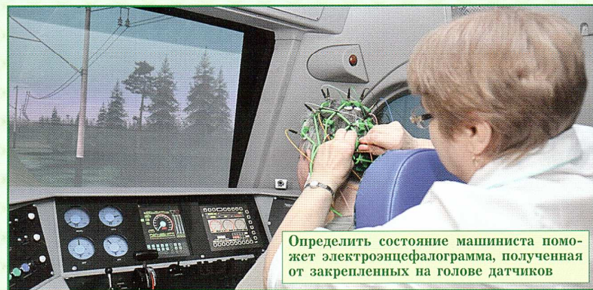
На контрольном столе по мониторам можно отслеживать действия машиниста и его психофизическое состояние, а также задавать различные нештатные ситуации
