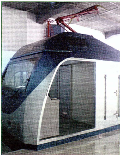
Рис. 1. Тренажер на базе кабины электровоза ЭП1М в выставочном зале ЦНТИБ ОАО «РЖД»
