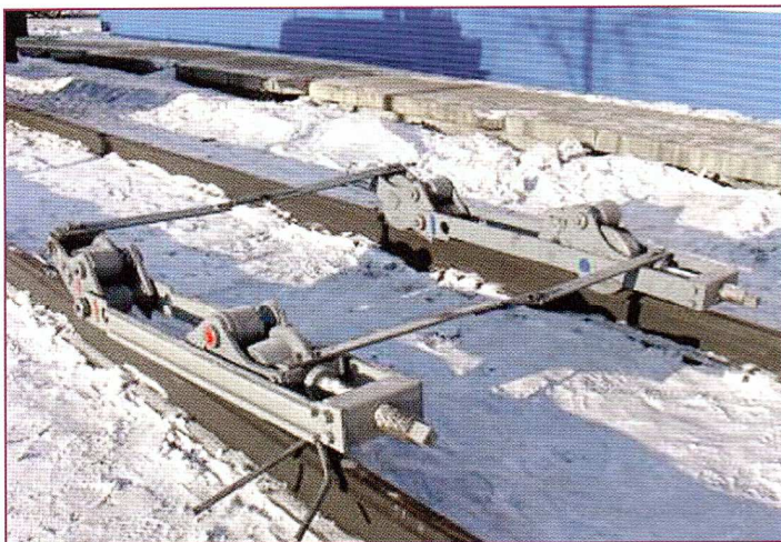
Рис. 3. Тележка-эвакуатор для вывоза паровоза ТЭП70БС конструкции Тындинского отделения Дальневосточной дороги
