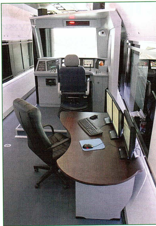
Рис. 4. Тренажерный комплекс электровоза ЭП1М, входящий в состав передвижного выставочно-лекционного комплекса ОАО «РЖД»
