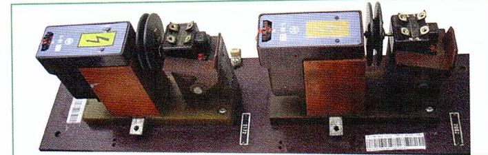
Рис. 33. Тепловые реле 1-RF электровазона ЧС7
