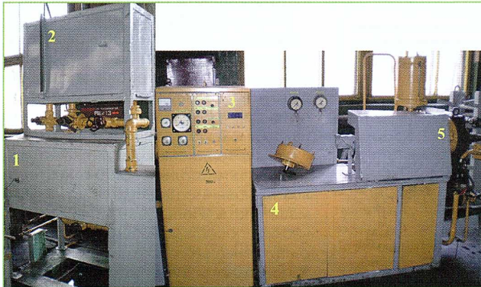
Рис. 1. Общий вид стенда: 1 — основной бак масла; 2 — мерный бак масла; 3 — пульт управления; 4 — рабочий стол; 5 — привод насоса, закрытый кожухом
