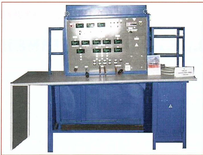
Рис. 2. Стенд для проверки и настройки автоматического регулятора напряжения, тип АЗ075
