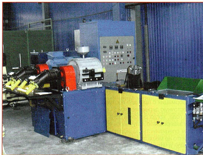
Рис. 3. Стенд для испытания гидромоторов тепловозов ТЭП70БС, 2ТЭ70, тип АЗ076
