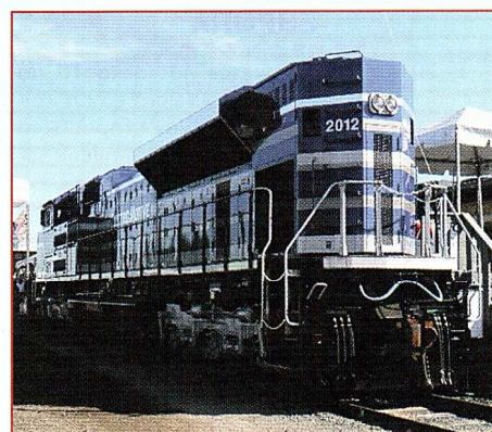
Тепловоз серии SD70ACe с передачей переменного тока компании EMD
