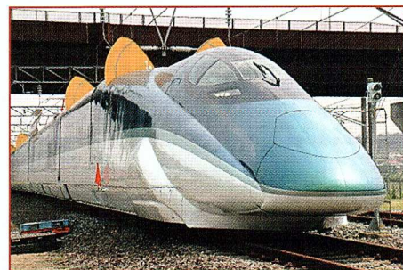
Экспериментальный высокоскоростной электропоезд «Fastech 360» с аэродинамическими «ушами», снижающими шум от токоприемников
