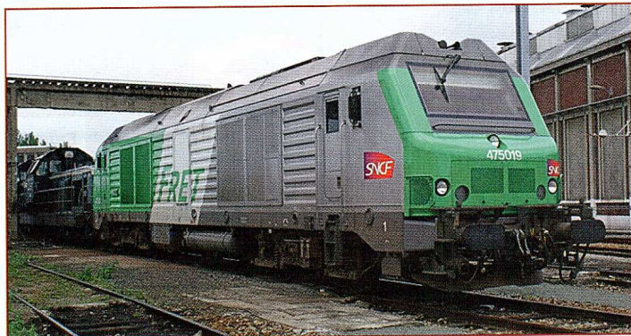
Тепловоз серии 75400 компаний «Alstom Transport» и «Siemens Mobility»
