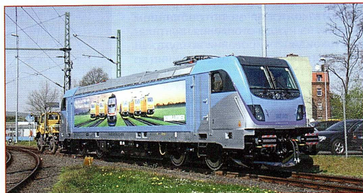
Грузовой электропоезд TRAXX-AC с асинхронным приводом и дополнительным дизелем компании «Bombardier»
