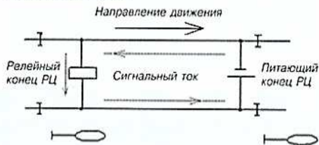
Рис. 2. Схема контроля занятости рельсовой цепи
