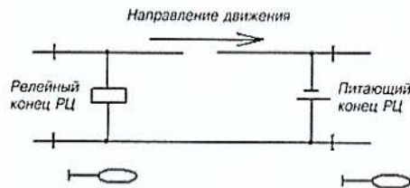
Рис. 1. Схема свободного состояния рельсовой цепи
