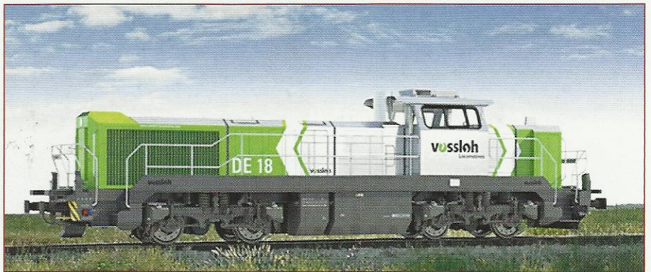
Тепловоз модульной конструкции компании «Vossloh Locomotives»
