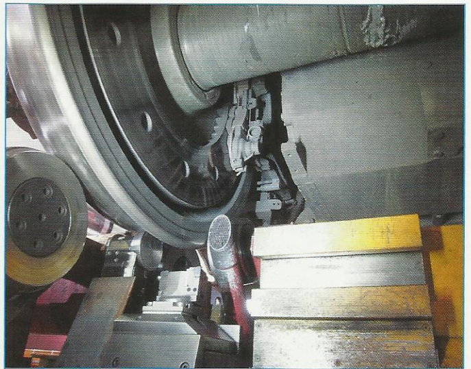
Рис. 5. Измерение профиля и диаметра колеса при обкатывании его контрольным роликом на колесотокарном станке U2000-400D «Hegenscheidt»
