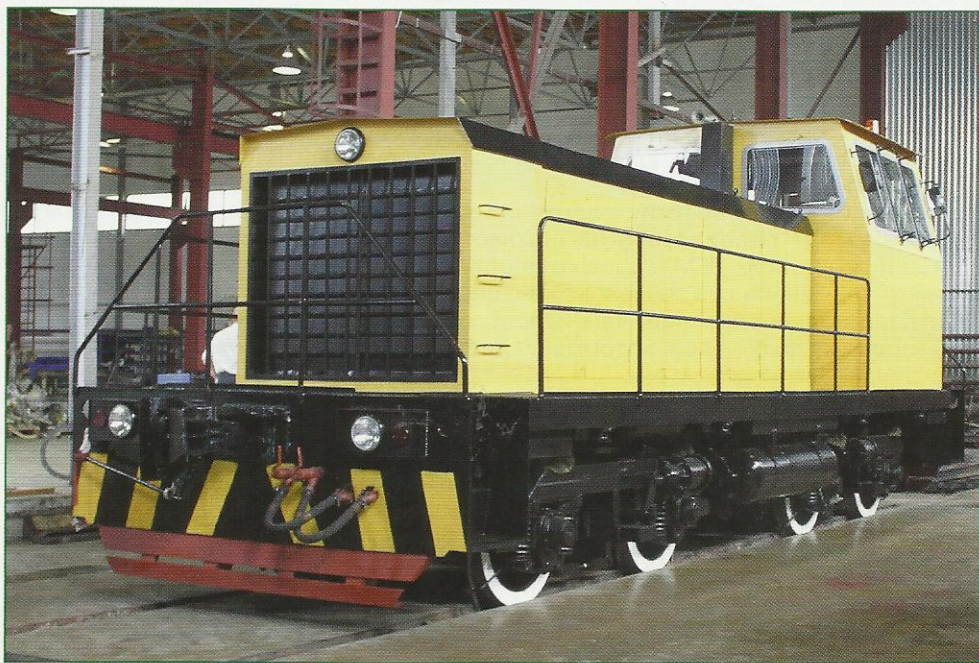
Рис. 3. Четырехосный тележечный тепловоз ТГМ50 мощностью от 400 до 600 л.с. На локомотиве модификации ТЭМ50 крутящий момент от дизеля к колесным парам передается с применением асинхронного привода
