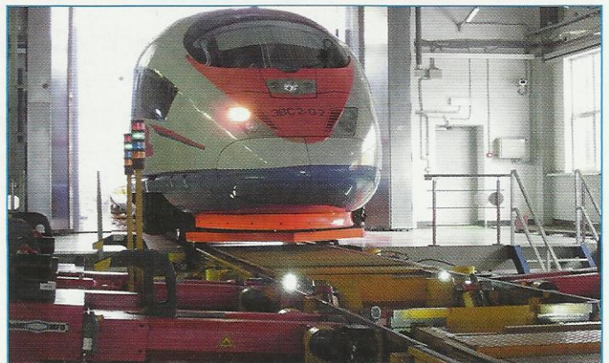
Рис. 2. Замеры геометрических параметров колес системой диагностики «Argus»
