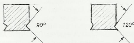
Рис. 4. Профили вставок: слева — серийная конструкция; справа — измененная форма
