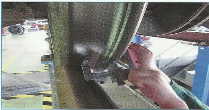
Рис. 3. Замеры геометрических параметров колес универсальным шаблоном УТ-1
