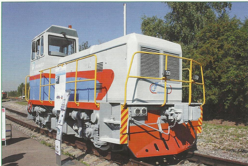
Рис. 4. Маневровый локомотив ЛГМ1 оборудован комбинированной силовой установкой, которая содержит модуль тяговых аккумуляторных батарей (от 145 до 286 кВт) и дизель-генераторную установку мощностью 60 или 100 кВт
