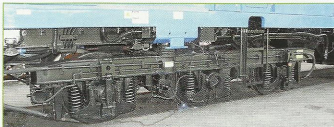
Рис. 4. На тепловозе применена трехосная челюстная тележка
