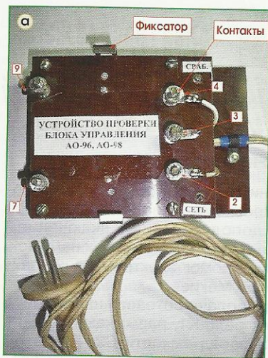
Рис. 3. Устройство проверки блока (а) и плата управления АО-96, установленная на устройство проверки (б)
