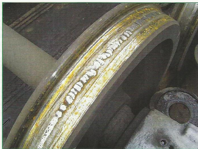
Рис. 2. Навары на рабочей поверхности колесной пары, имеющие чешуйчатый вид
