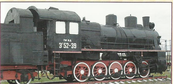
Паровозы серии 9 Г строились в Германии в начале 20-х годов XX в. сначала на заводе Геншеля, а потом на заводе Вольфа
