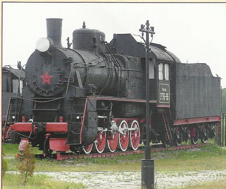
Паровозы 9 Р , реконструированные из серии 9 М в начале 1930-х годов на Муромском заводе, эксплуатировались на многих дорогах и имели мощность на 10 — 15 % выше своих предшественников
