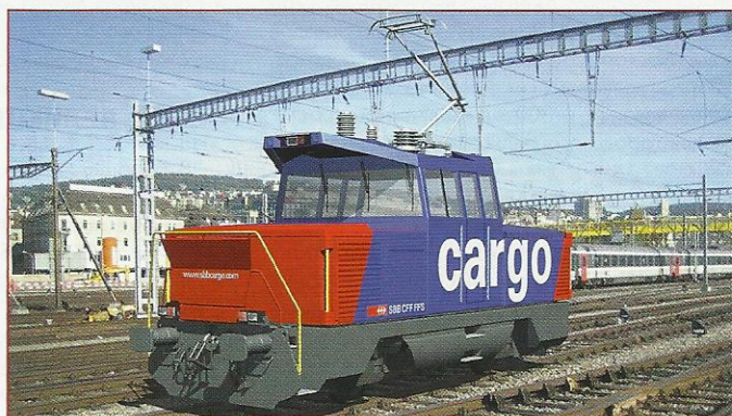
Двухосный гибридный маневровый локомотив серии Eem 923 фирмы «Stadler Winterthur AG»
