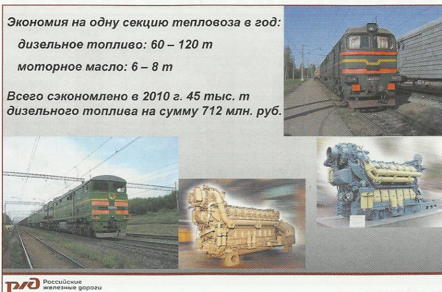
Рис. 4. Модернизация тепловозов типа ТЭ10 и М62 с заменой двухтактных дизелей на четырехтактные
