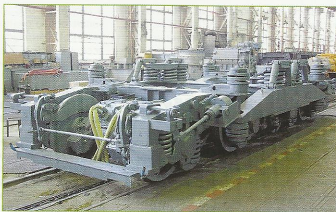
Рис. 2. Четырехосная тележка состоит из двухосных, соединенных между собой промежуточной рамой. Рессорное подвешивание — двухступенчатое
