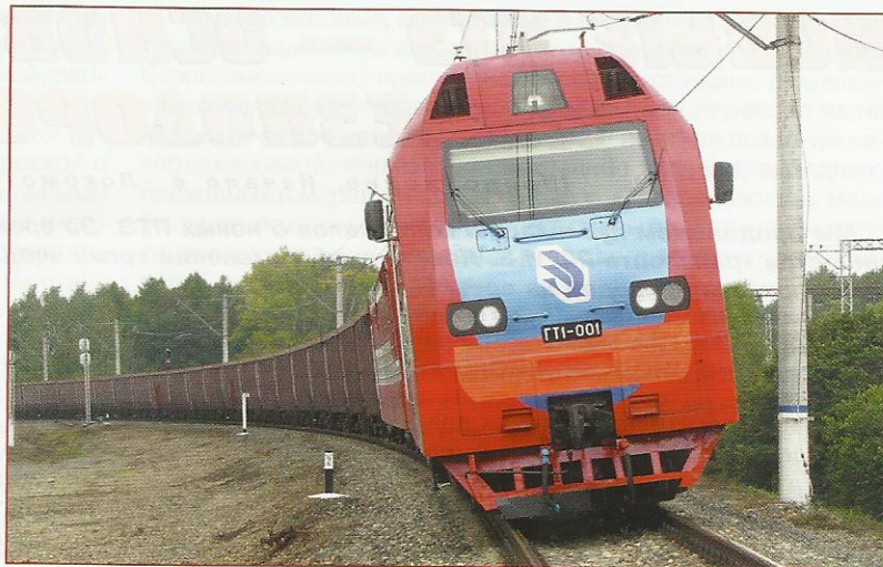
Экспериментальный газотурбовоз ГТ1, созданный специалистами «РЖД» и учеными ВНИКИ, провез состав весом 16 тыс. т
