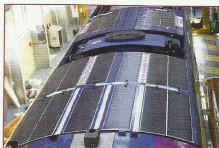
Модуль фирмы «Ascent Solar Technologies», установленный на крыше регионального поезда
