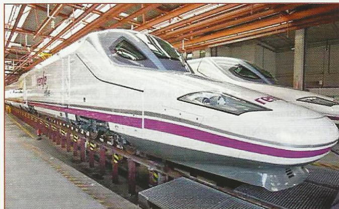
Высокоскоростной электропоезд AVE S 112
