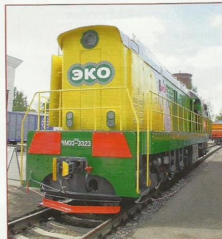
Модернизированный тепловоз ЧМЭЗ Эко -3323 оборудован тремя дизель-генераторными установками
