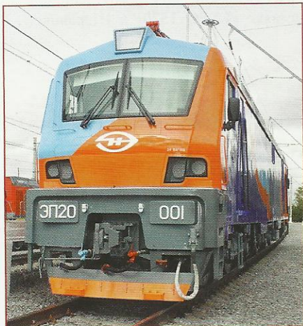
Главная новинка на «EXPO 1520» — пассажирский электровоз двойного питания с асинхронным тяговым приводом ЭП20
