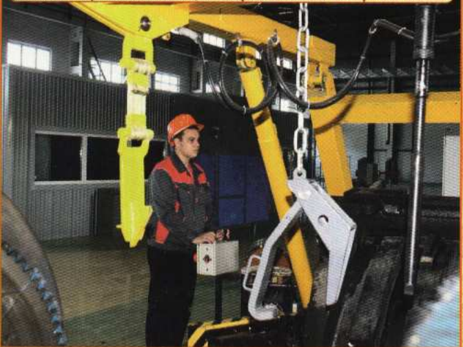
Автоматизированная позиция сборки колесно-моторного блока
