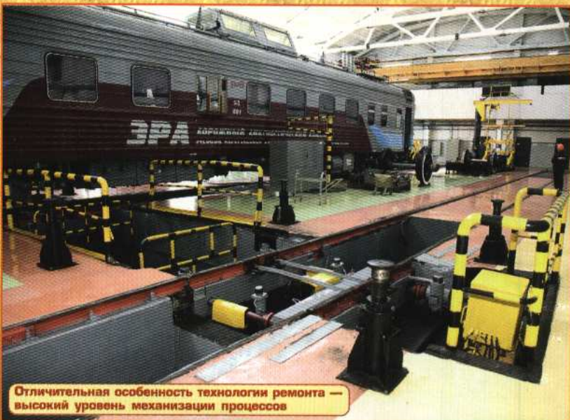
Автоматизированная позиция сборки колесно-моторного блока
