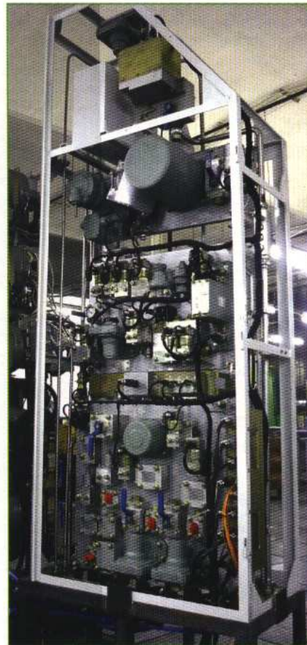
Рис. 2. Модуль тормозного оборудования Е.311 (вид спереди, дверцы и боковая стенка сняты)
