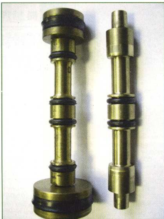
Рис. 7. Узел штока воздухораспределителя 5VC
