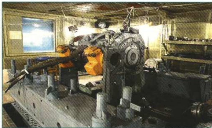
Вибрационный стенд СТ68 для испытаний тягового электродвигателя ЭД-107
