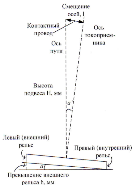
Рис. 2. Расчетная схема для определения величины смещения оси токоприемника от оси пути:
