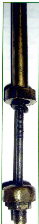
Рис. 2. Узел клапанов вентиля ЭВ-58 с неисправным верхним резиновым уплотнением
