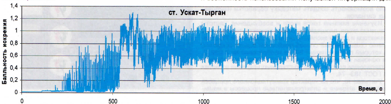
Рис. 5. Мониторинг искрения одного ТЭД ДТК-800 электроваза 2ЭС4 № 007 (март 2009 г.) на полигоне Белово – Междуреченск
