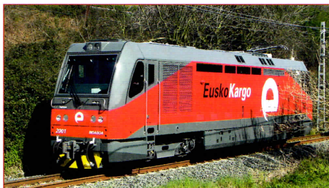
Гибридный локомотив TD 2000 испанских компаний CFD и CAF
