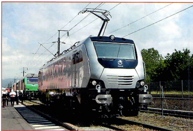
Четырехсистемный грузовой электровоз модульного типа «Prima II» компании «Alstom»
