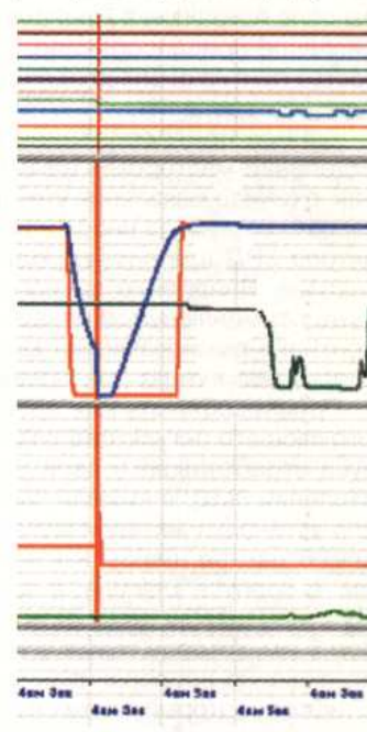
Рис. 9. Отсутствие опробования автоматического тормоза до начала движения
