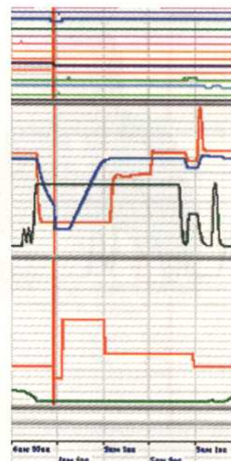
Рис. 5. Несвоевременное перекрытие комбинированного крана в оставляемой кабине
