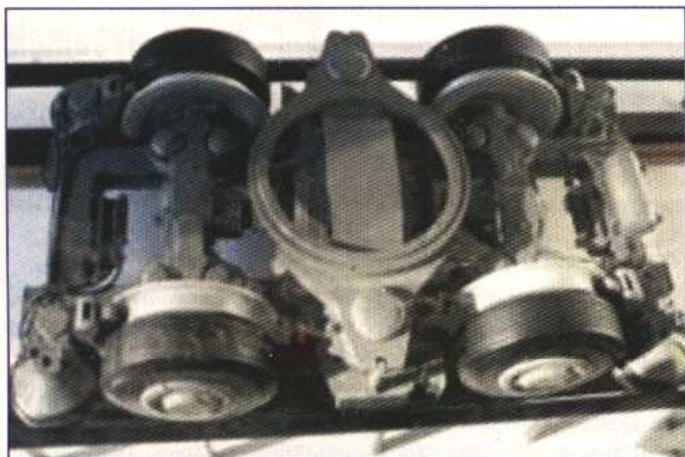
Рис. 3. Ходовая тележка системы «Метро-метеор»
