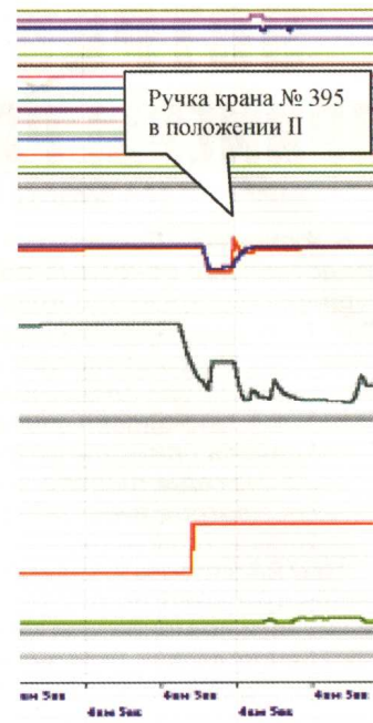
Рис. 8. Чувствительность воздухораспределителей к отпуску
