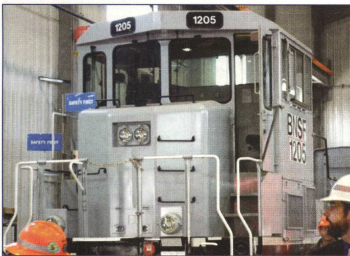
Рис. 9. Гибридный маневровый локомотив массой 127 т и мощностью 250 кВт
