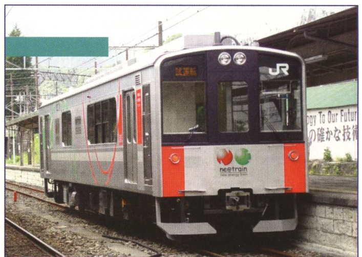
Рис. 10. Гибридный поезд, оснащенный водородным топливным элементом
