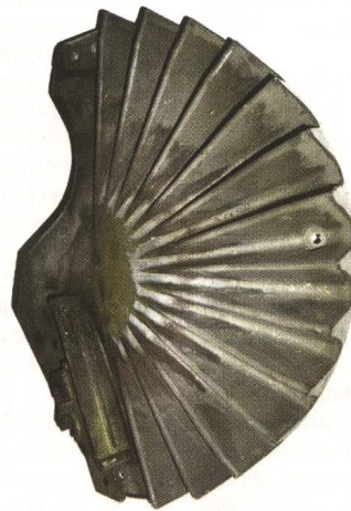
Рис. 15. Боковина лабиринто-щелевой камеры
