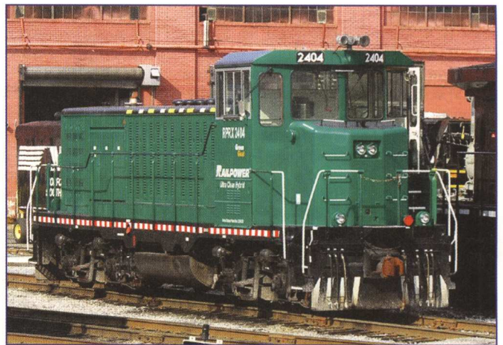
Рис. 8. Гибридный маневровый локомотив «Green Goat — GG20B»
