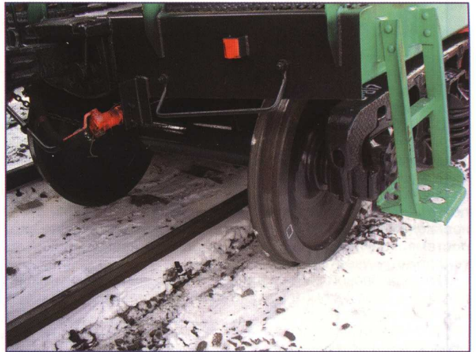
Сход — результат проезда на станции Калининград-Сортировочный
