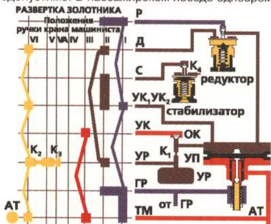
Рис. 1. Схема действия крана машиниста № 394 (395): Р — канал редуктора; Д — канал диафрагмы; С — канал стабилизатора; К 1 , К 2 , К 3 , К 4 — калиброванные отверстия; УК 1 , УК 2 — каналы уравнильной камеры; ОК — обратный клапан
