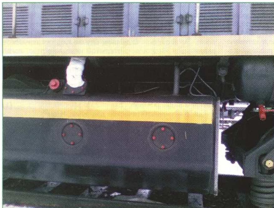
Рис. 2. Установка датчиков на топливном баке
