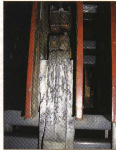
Рис. 5. Дугогасительный рог переключателя 18КН
