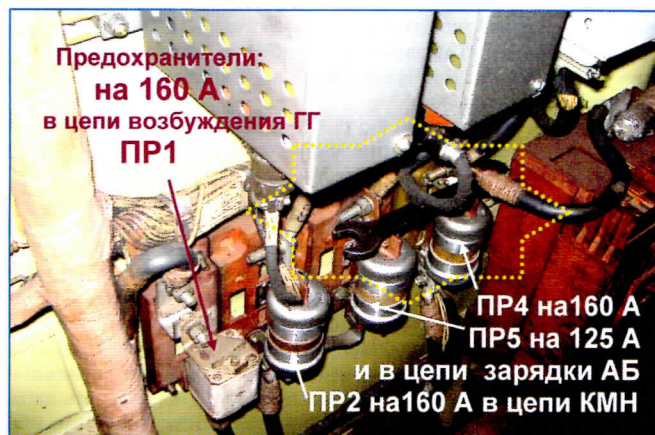
Рис. 6. Аварийная схема при выходе из строя стартер-генератора
