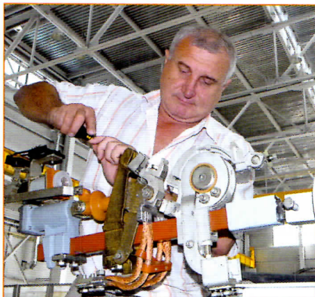
Н.В. Семёнов из НИИТКД демонстрирует технологию ремонта электропневматических контакторов на специализированном рабочем месте
