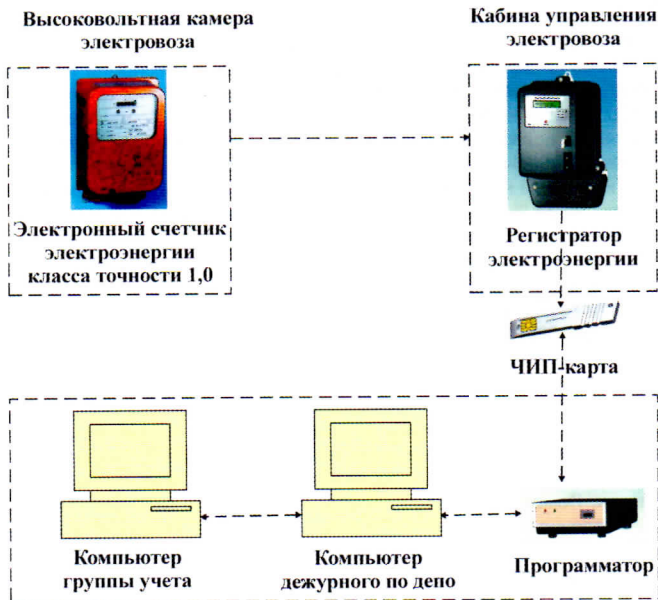
Рис. 2 Автоматизированный учет электроэнергии на электроподвижном составе и использованием счетчиков СКВТ Ф610
