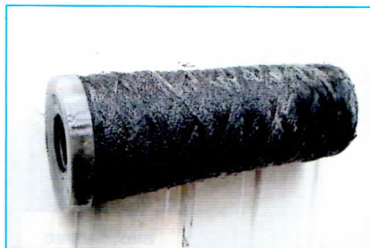
Рис. 3. Элемент топливного фильтра тепловоза ЧМЭЗ за месяц работы в начале опытной эксплуатации на биодизельном топливе
