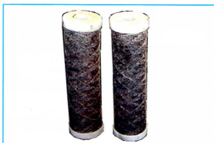
Рис. 4. Элементы топливных фильтров тепловоза ЧМЭЗ за месяц работы в конце опытной эксплуатации на биодизельном топливе
