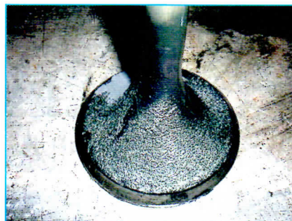
Рис. 7. Клапан цилиндровой крышки тепловоза ЧМЭЗ после испытаний на биодизельном топливе
