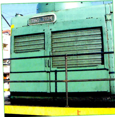
Общий вид и схема монтажа металлических штор для жалюзи холодильника на тепловозе ТЭМ2-7034 (через дробь указаны размеры соответственно для широких и узких створок жалюзи)
