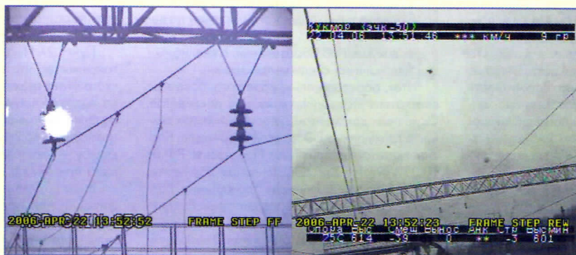
Пример изображений смещенного ультрафиолетового видимого диапазона (слева) и снятых видеокамерой вагона измерения контактной сети во время испытательного объезда (справа)
