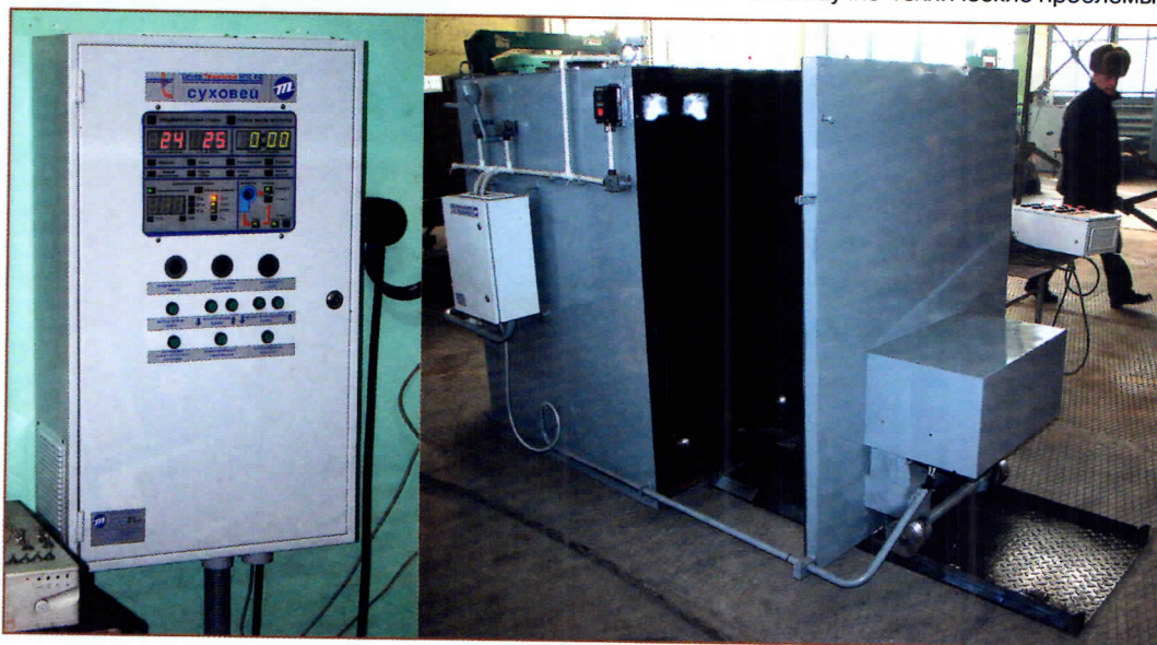
Система «Суховей» с сушильной камерой
