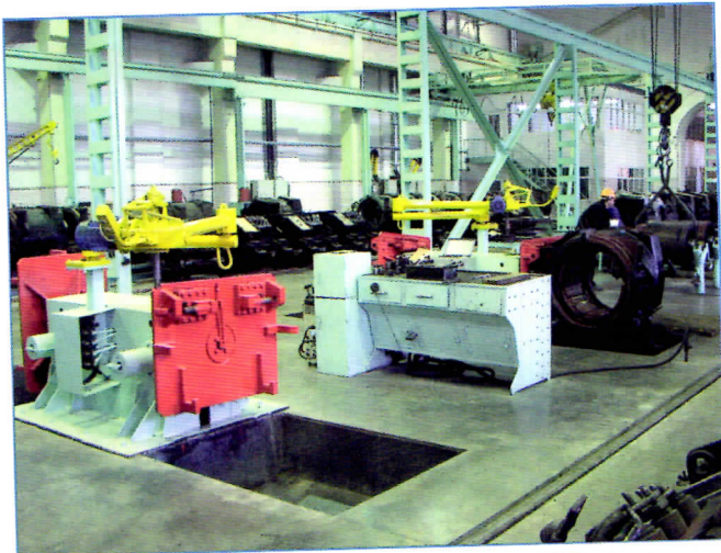
Внедрение кантователя для сборки-разборки ТЭД значительно облегчило работу ремонтников
