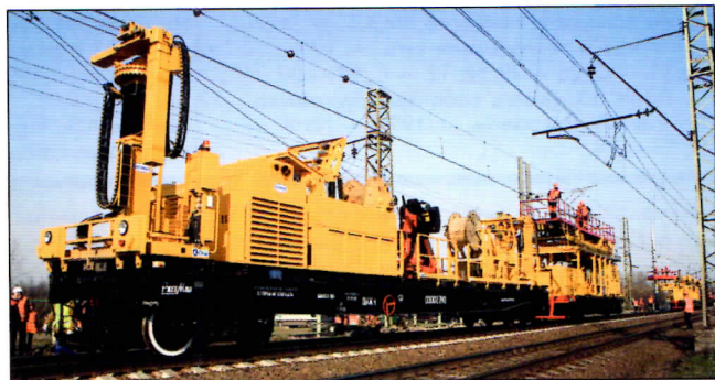
Машина ДНЖ-1 в процессе сматывания контактных проводов
