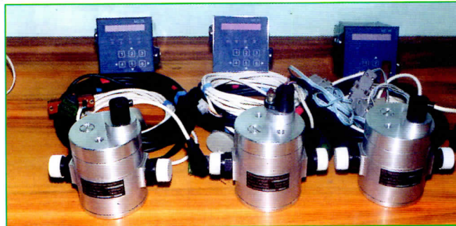
Рис. 5. Ролико-лопастные расходомеры НОРД-20 и вторичные измерительные приборы МС-75 нового поколения
