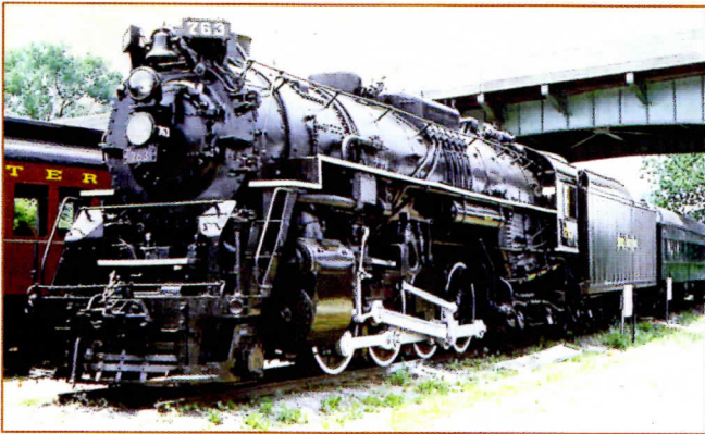
Паровоз класса 2-8-4 постройки 1944 г. (американская формула считает реальные колеса, а не оси)
