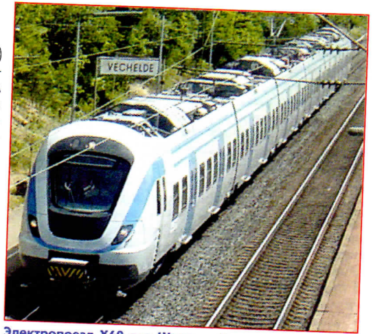
Электропоезд Х60 для Швеции. Видны размещенное на крыше оборудование и криволинейные стенки кузова вагона
