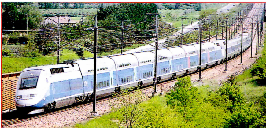
Двухэтажный электропоезд «Дуплекс» в сцепе с одноэтажным, тяговый вагон которого трехсистемный. На ст. Лилль хвостовая одноэтажная часть поезда отцепляется для самостоятельного следования до ст. Брюссель-Миди
