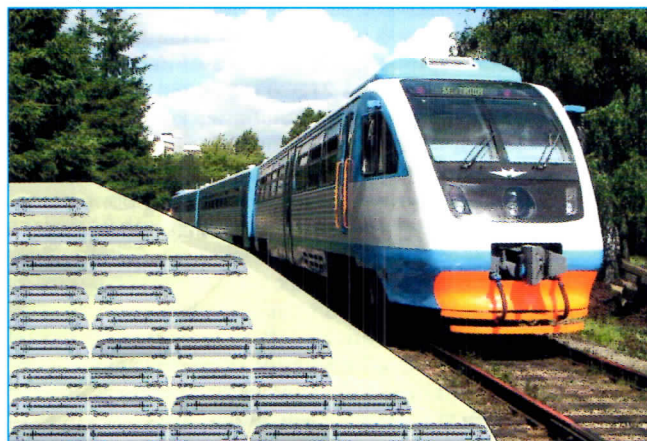
Рельсовый автобус РА2 и варианты его составности
