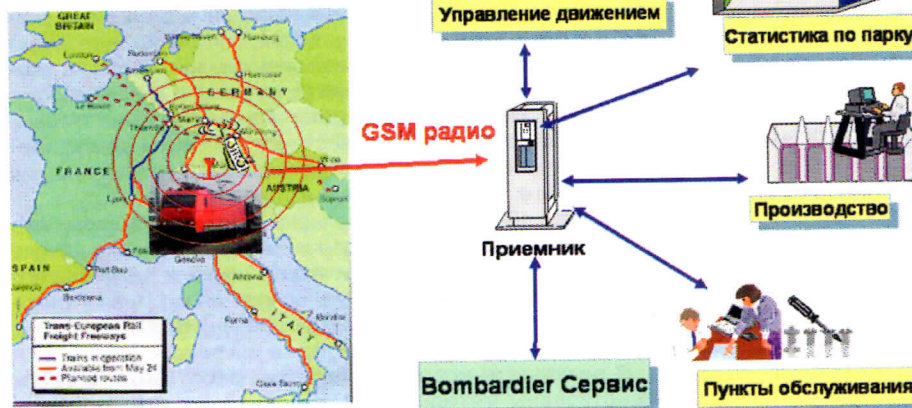
Рис. 5. Система дистанционного контроля данных диагностики
