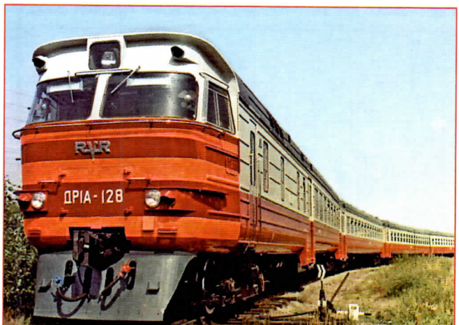
В 1976 г. Рижский завод приступил к выпуску дизель-поездов ДР1А (начиная с № 122) в традиционной составности — без промежуточных кабин управления
