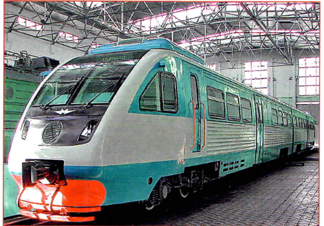
Новый рельсовый автобус РА2 Мытищинского завода может работать в двух-, трех- и четырехвагонном составе
