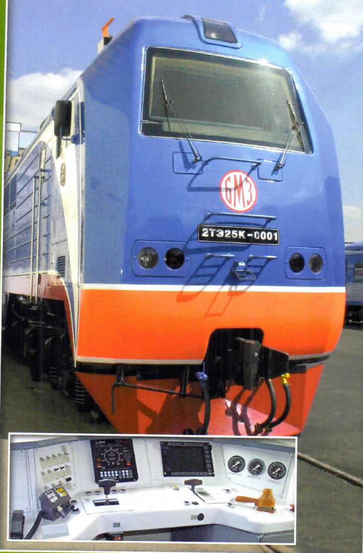
Органы управления УКТОЛ тепловоза 2ТЭ25К «Пересвет»
