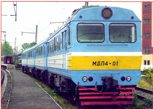
Небольшой пассажирский дизель-поезд МДП4, созданный Людиновским тепловозостроительным заводом в 1995 — 1996 годах
