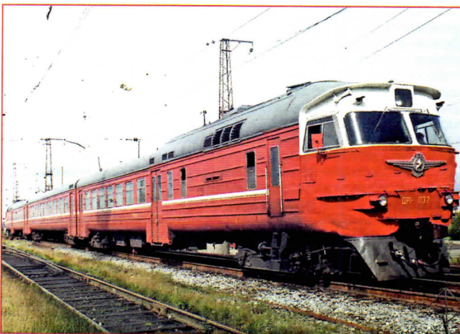
Первый отечественный дизель-поезд ДР1 (два головных моторных вагона и два прицепных), созданный специалистами Рижского вагоностроительного завода (1963 г.)
