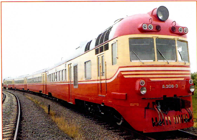
Усовершенствованный в 1964 г. заводом «Ганц-Маваг» четырехвагонный дизель-поезд Д1
