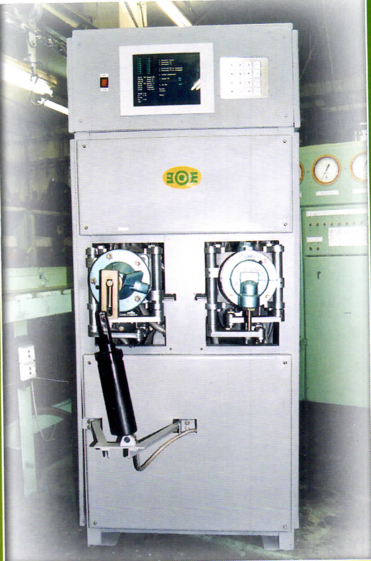
Автоматический электронно-пневматический стенд проверки воздухораспределителей типа № 483
