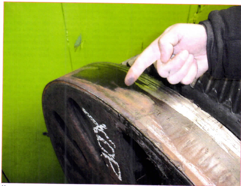
На колесном центре после удаления бандажа отчетливо видны места неприлегания
