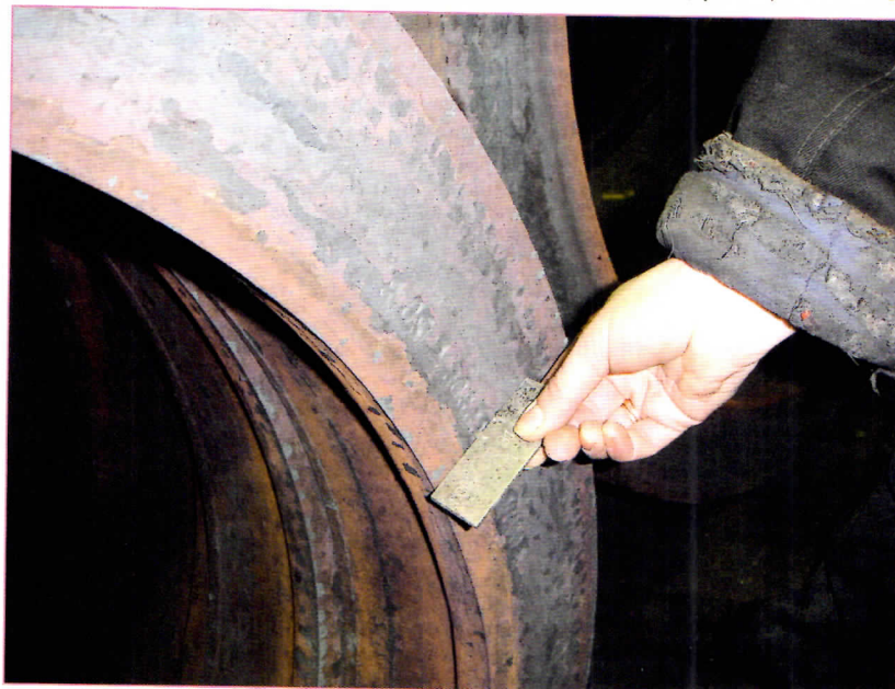
Измерение глубины нанесения клейм на Нижнетагильском металлургическом комбинате
