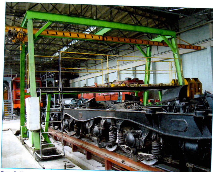
Рис. 2. На технологическом участке разборки-сборки тележек электровоза ЭП1
