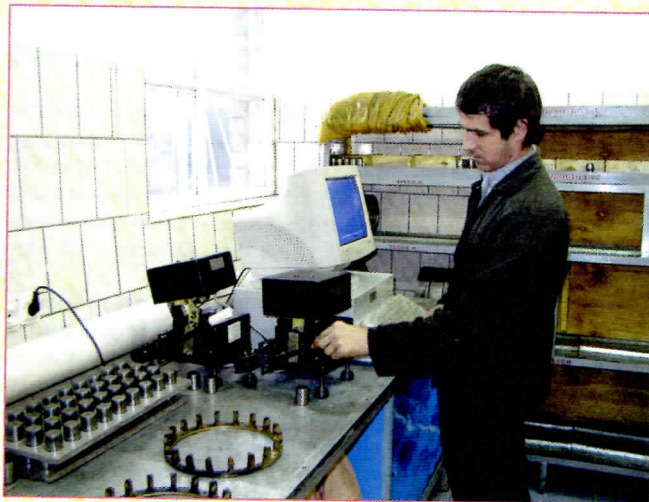
Установка подбора роликовых подшипников
