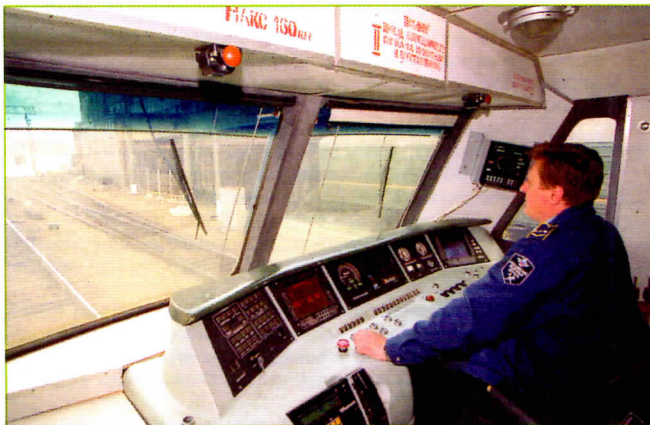
Рис. 4. Вид кабины и аппаратуры КЛУБ-У с места машиниста
