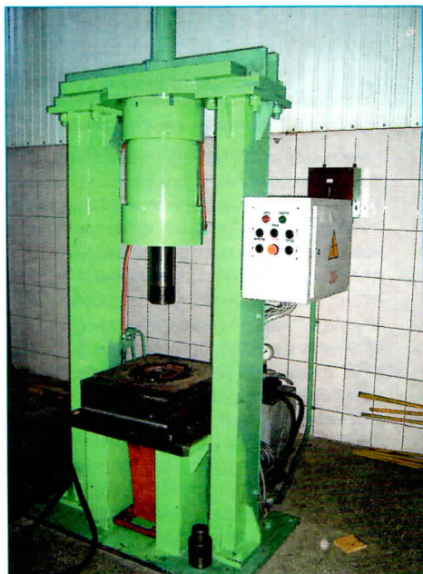
Рис. 7. Гидропресс для демонтажа зубчатых колес
