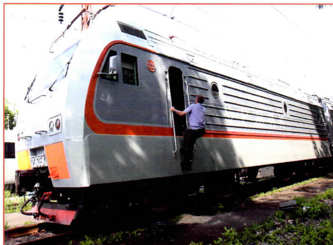
В Научно-испытательном центре ВНИИЖТа члены секции досконально осмотрели электровоз 2ЭС5К «Ермак»
