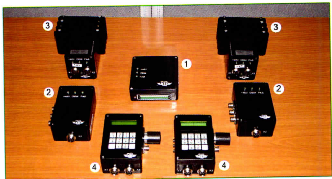
Рис. 2. Комплект аппаратуры РПДА-П для электровоза ЧС200: 1 — блок ввода дискретных сигналов БДВ-3; 2 — блок ввода аналоговых сигналов БАВ-1; 3 — высоковольтный блок измерения БИВМ-1; 4 — блоки регистрации БР-1 (слева) и накопления информации БНИ-9 (справа)
