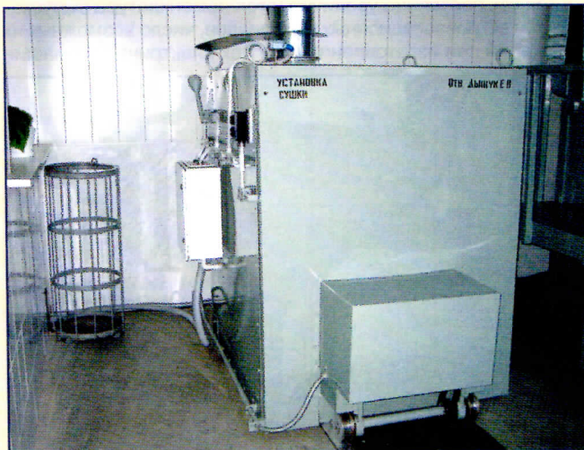
Камера для сушки якорей и остовов ТЭД с автоматическим контролем сопротивления изоляции обмоток, не допускающим искусственного старения изоляции
