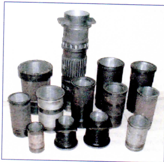
Рис. 2. Восстановленные втулки и цилиндры компрессоров
