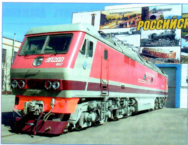
Скоростной восьмиосный пассажирский электровоз переменного тока ЭП200
