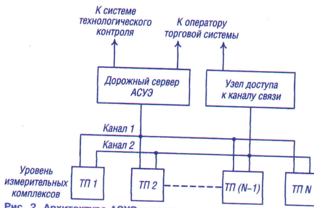
Рис. 2. Архитектура АСУЭ тягового электроснабжения
