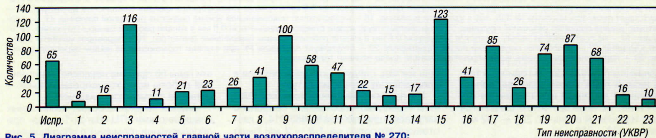
Рис. 5. Диаграмма неисправностей главной части воздухораспределителя № 270:
