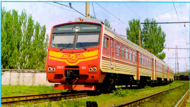
Восьмивагонный электропоезд постоянного тока ЭП12Т (ЭП12Т), изготавливаемый с 2001 г. ОАО ХК «Лугансктепловоз». Оборудован реостатным, рекуперативным и электропневматическим тормозами
