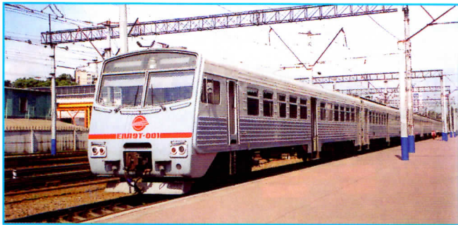
Восьмивагонный электропоезд переменного тока ЭП19Т (ЭП19Т) повышенной комфортности, выпускаемый с 2002 г. ОАО ХК «Лугансктепловоз». Оборудован реостатным и электропневматическим тормозами
