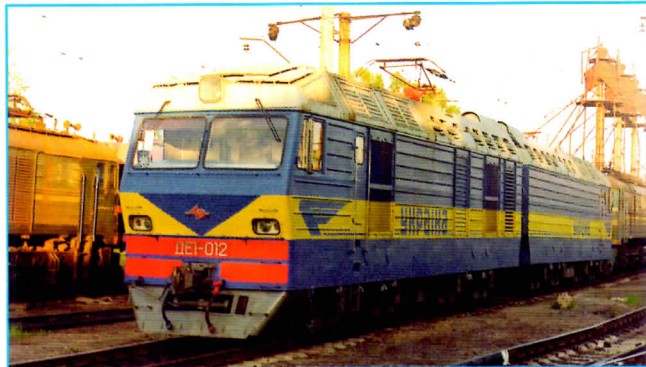
Грузовой двухсекционный 8-осный электровоз постоянного тока ДЕ1 (ДЭ1) мощностью 6260 кВт, выпускаемый с 1993 г. государственным предприятием «НПК «Электровозостроение». Имеет рекуперативное торможение, микропроцессорную систему диагностики
