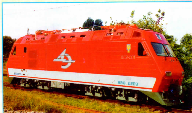
Грузопассажирский электровоз ДС3 переменного тока мощностью 4800 кВт с асинхронным приводом. Опытный образец построен в 2002 г. ГП «Днепропетровский НПК «Электровозостроение» совместно с немецкой фирмой «Siemens»
