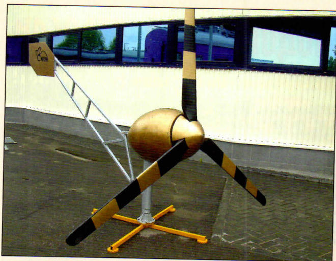
Трехлопастной ветрогенератор фирмы «Сапсан» с горизонтальной осью вращения, автоматический поворот которой перпендикулярно ветровому потоку обеспечивает крыло-стабилизатор
