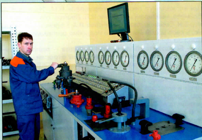
Разработанный ПКБ ЦТ стенд для проверки автотормозного оборудования хорошо зарекомендовал себя в депо Волховстрой Октябрьской дороги
