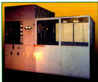
Рис. 5. Стенд для испытания изоляции
