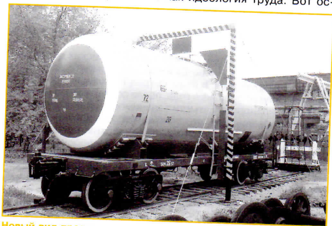
Новый вид продукции — железнодорожная цистерна, сваренная из листов металла продольными швами
