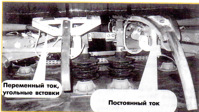
Токоприемники типа АХ переменного (слева) и постоянного (справа) тока на французской электросекции ZTER
