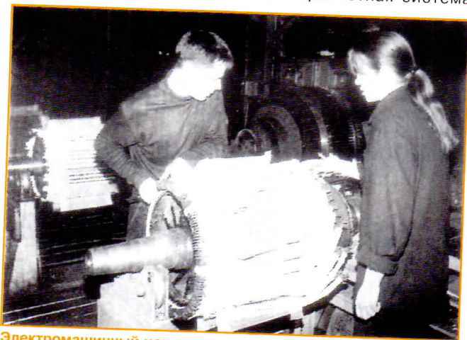
Электромашинный цех оснащен технологическим оборудованием для ремонта электрических машин тепловозов
