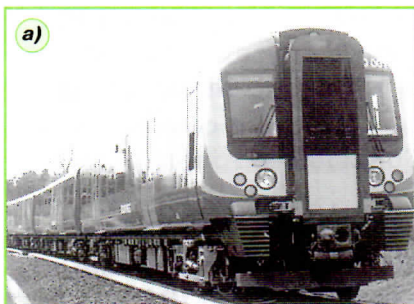
Концевые вагоны поезда «Desiro UK» с предусмотренным сквозным проходом (а) и без сквозного прохода (б). Снимок сделан в ходе испытаний в Германии на участке Вегберг — Вильденрат
