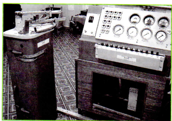
В кабинете «Электровагоны постоянного тока» имеется тренажер «Мнемосхема электрических цепей электровагона ВЛ10 с пультом управления»
