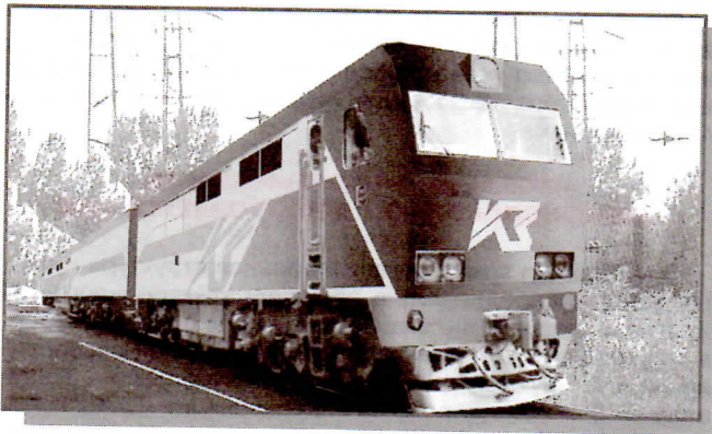
Дизайн-проект грузового тепловоза 2ТЭ70. Мощность шестисекционной секции по дизелю 4080 л.с. (3000 кВт), мощность электрического тормоза 3200 кВт, конструкционная скорость 110 км/ч, сила тяги продолжительного режима 304 кН (31 тс), нагрузка от колесной пары на рельсы 23,5 тс
