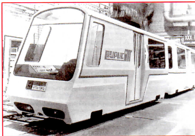
Головной вагон с кабиной управления поезда «Турист», построенного Рижским вагоностроительным заводом (1975 г.) для эксплуатации на путях (900 мм) туристского комплекса в Новом Афоне
