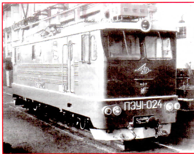
Электровоз ПЭУ1, изготовленный на Днепропетровском электровозостроительном заводе для работы на линиях колеи 750 мм, электрифицированных на постоянном токе напряжением 550 В
